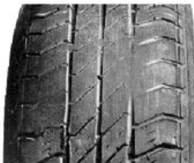
Figura 1. 15 Desgaste mecánico en el neumático
