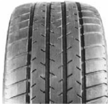
Figura 1. 18 Desgaste en los extremos
