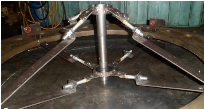
Figura 4. 7 Eje central con templadores
