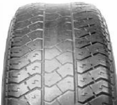
Figura 1. 17 Desgaste asimétrico en el centro
