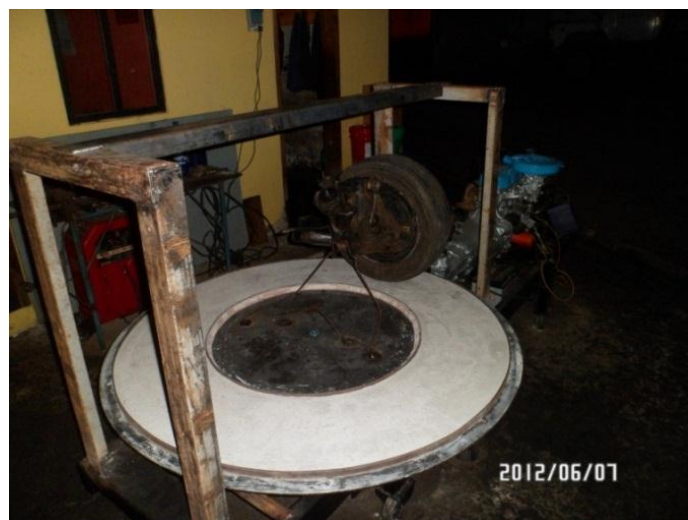
Figura 4. 3 Marco estructural de sujeción de la estructura base e la llanta neumática
