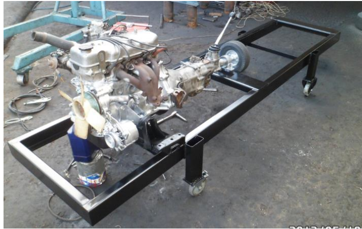
Figura 4. 2 Construcción de la estructura del chasis
