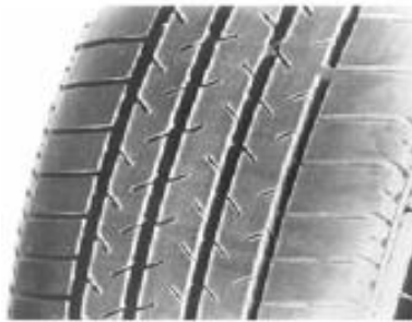
Figura 1. 16 Desgaste asimétrico en el neumático
