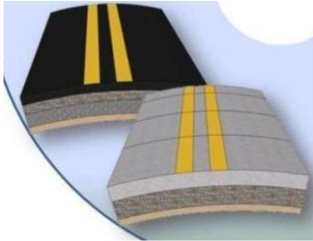
Figura 1. 26 Concreto y asfalto
