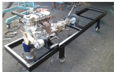
Figura 6 Construcción de la estructura del chasis
