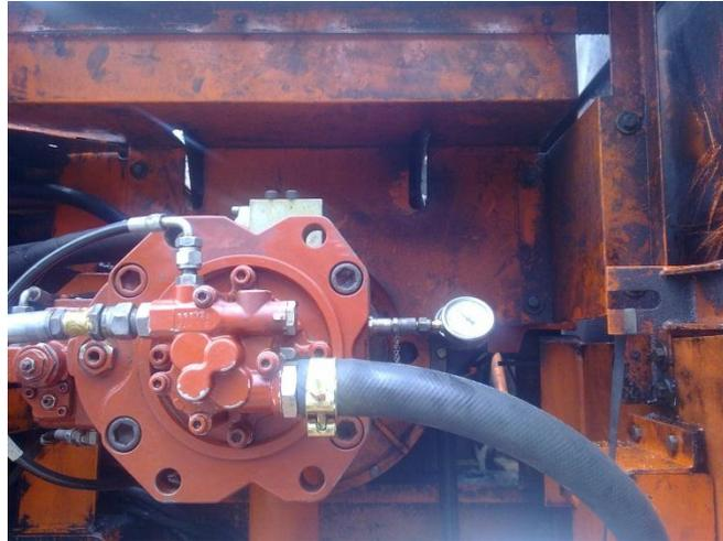
**Figura 4.15 Manómetros Conectados en Bomba Hidráulica. (Forma convencional)**
