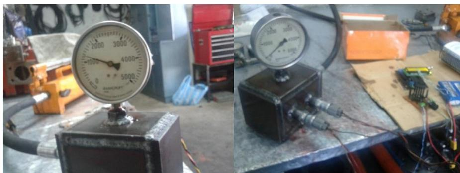
**Figura 4.10 Manómetro de Calibración.**
