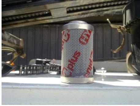
**Figura 2.13 Filtro Hidráulico Excavadora Daewoo.**
