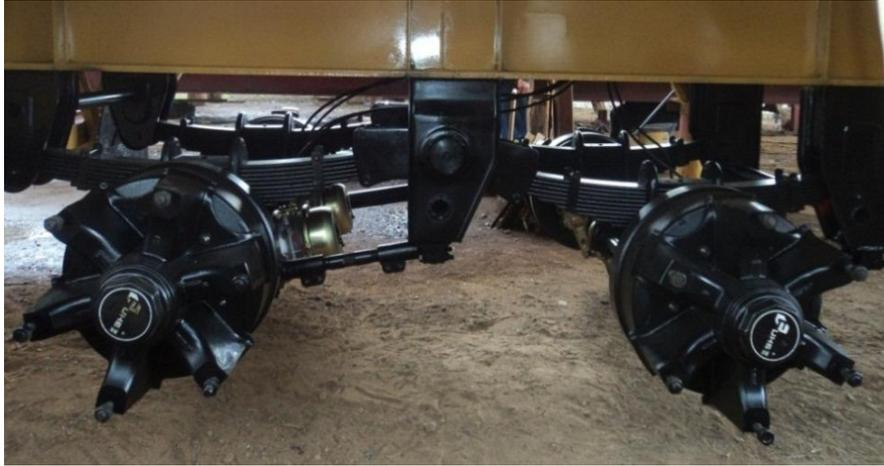
**Figura N° 11:** Sistema de Suspensión.<sup>21</sup>
