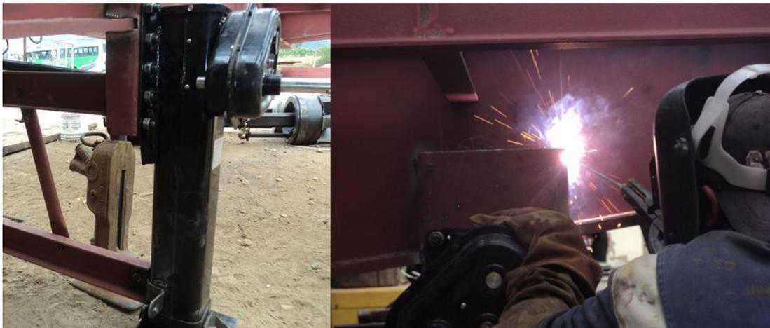
**Figura N° 95:** Montaje de las patas de apoyo.<sup>131</sup>
