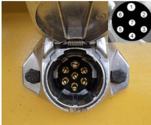
**Figura N° 81:** Conexión del enchufe de 7 polos hembra.<sup>111</sup>
