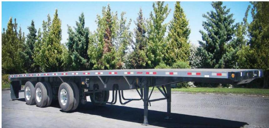
**Figura N° 2:** Plataforma Cama alta de tres ejes.<sup>5</sup>
