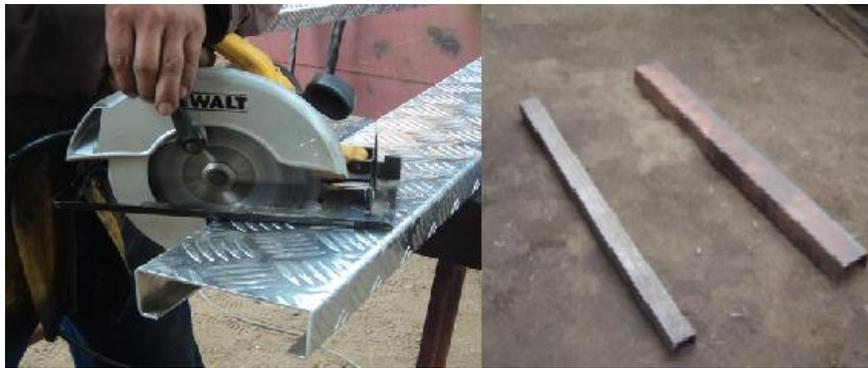
Figura N° 97: Corte de perfilería.<sup>133</sup>
