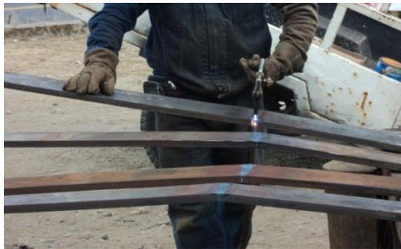
**Figura N° 88:** Doblado de platinas para chasis.<sup>122</sup>
