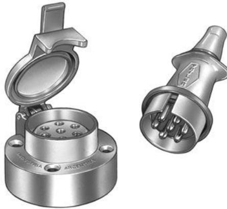
**Figura N° 28:** Enchufe eléctrico de 7 polos.<sup>41</sup>
