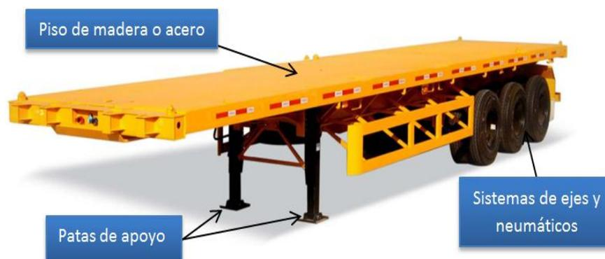
**Figura N° 9:** Plataforma cama alta.<sup>14</sup>
