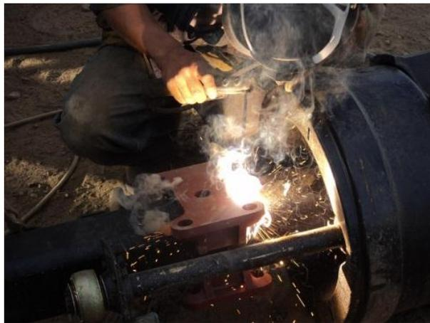
**Figura N° 92:** Soldadura de ejes.<sup>128</sup>
