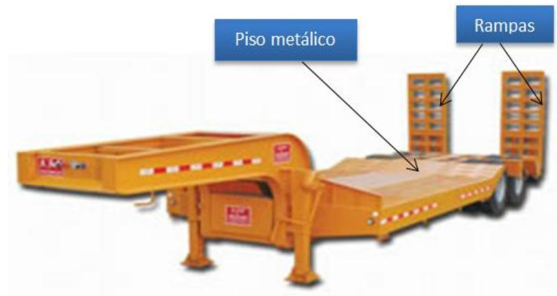
**Figura N° 6:** Plataforma cama baja<sup>11</sup>
