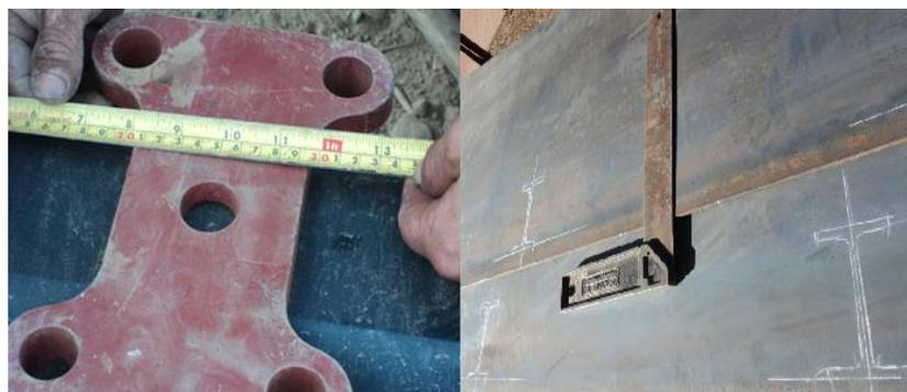
**Figura N° 86:** Marcado de los perfiles.<sup>118</sup>
