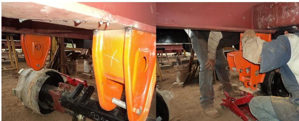
**Figura N° 93:** Montaje de Sistema de Suspensión.<sup>129</sup>
