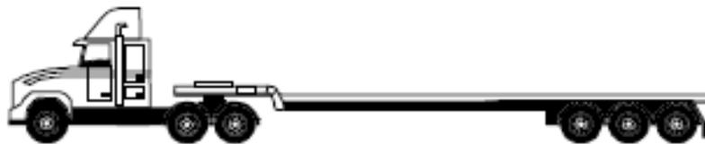
**Figura N° 16:** Sistema de ejes tridem.<sup>26</sup>
