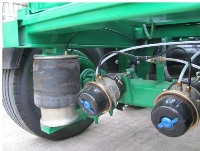
**Figura N° 13:** Sistema de suspensión neumática.<sup>23</sup>
