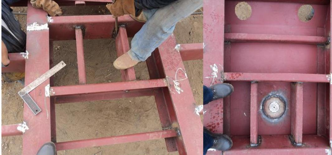
**Figura N° 94:** Montaje plancha con King pin.<sup>130</sup>
