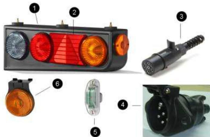
Figura N° 80: Sistema eléctrico.<sup>110</sup>
