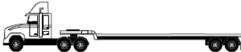
**Figura N° 15:** Sistema de ejes tándem.<sup>25</sup>
