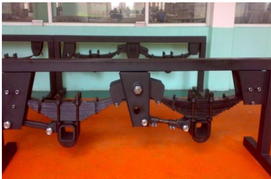
**Figura N° 12:** Sistema de suspensión mecánica.<sup>22</sup>
