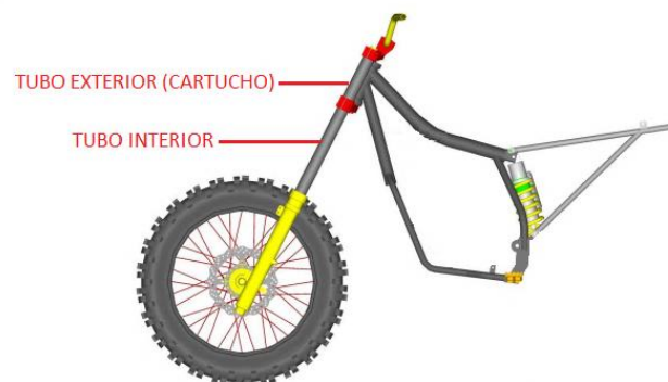
Figura 1.23 Suspensión delantera del prototipo Moto-Oruga, tipo Horquilla telescópica con un recorrido de suspensión total de 130 mm
