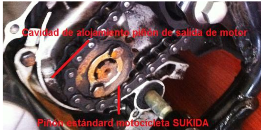
Figura 3.4 Cavidad de alojamiento del piñón original de salida de motor, de la motocicleta SUKIDA® (SK250GY-4)
