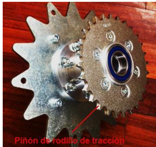
Figura 3.3 Piñón de rodillo de tracción de oruga de 28 dientes
