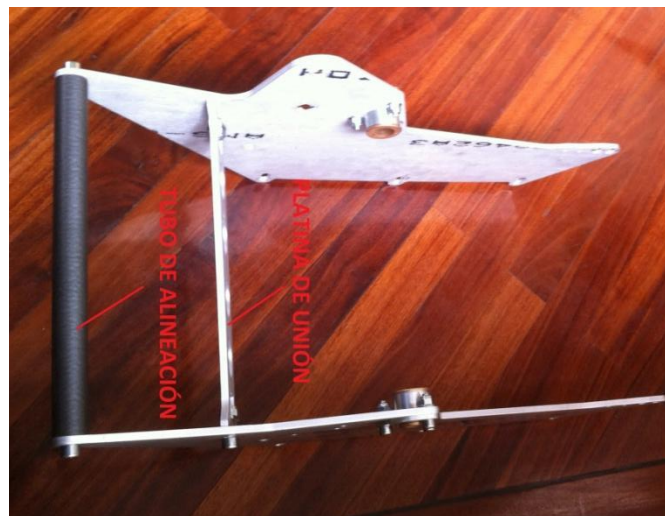
Figura 3.10 Elementos de alineación y unión de los soportes del tren de rodaje de oruga superior
