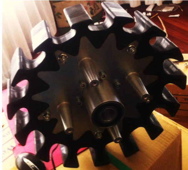
Figura 3.16 Ensamblaje final del conjunto de rodillo de tracción.
