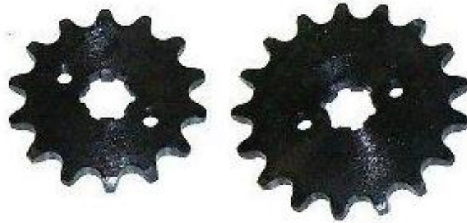
Figura 3.2 Sustitución de piñón original de 14 dientes por piñón de 17 dientes
