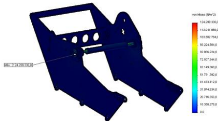
Figura 5. ESFUERZO MÁXIMO ESTÁTICO El esfuerzo máximo en el análisis estático distribuido en la estructura dos del mecanismo de oruga es 24 MPa con un factor de seguridad de 3.88
