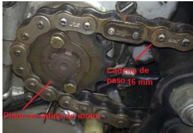
Figura 3.6 Piñón de salida de motor con cadena de transmisión DC520 MZX
