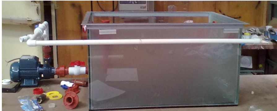
Figura 3.7: Línea de recirculación forzada.
