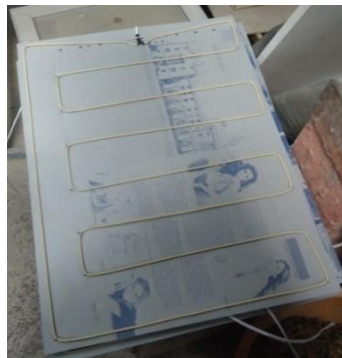
Figura 3.3: Resistencia desempañadora de vidrio de 80 W.
