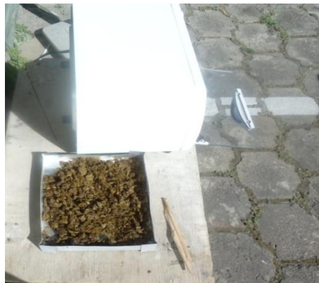
Figura 3.12: Biomasa de ganado antes de realizar la prueba de MS.
