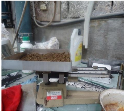
Figura 3.13: Pesado de biomasa de ganado después de la prueba.
