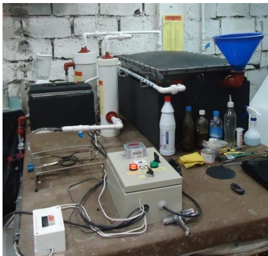
Figura 3.11: Biodigestor en funcionamiento.
