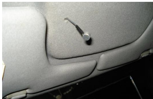
Figura 74: Ubicación del Easy Vr interior del tapizado techo del vehículo
