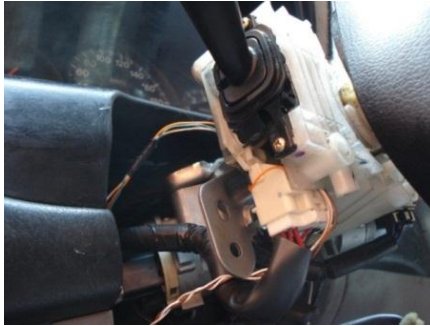
Figura 59: Conexión palanca de guías-medias-altas
