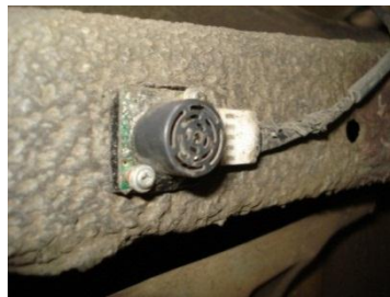
Figura 70: Instalación de sensor de peso en chasis
