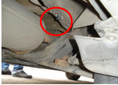
Figura 70: Instalación de sensor de peso en chasis
