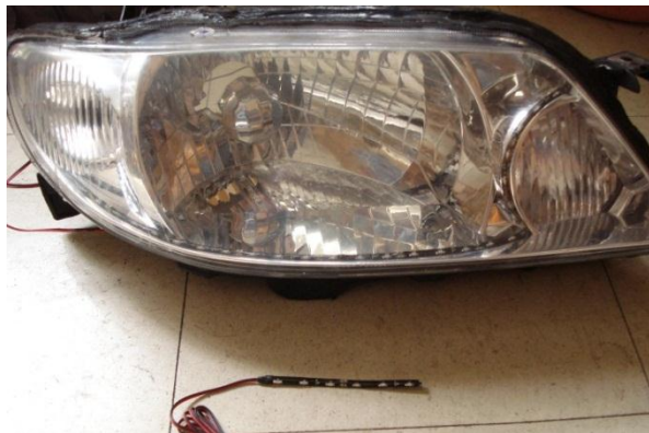
Figura 12: Tira de leds ubicada en los faros
