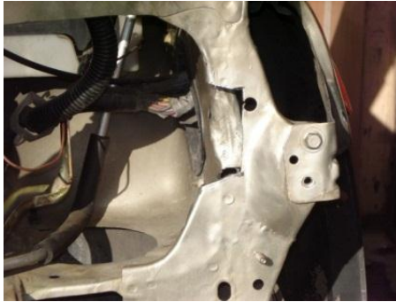
Figura 67: Modificación de carrocería para faros
