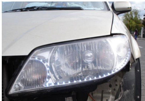
Figura 58: Encendido luces diurnas
