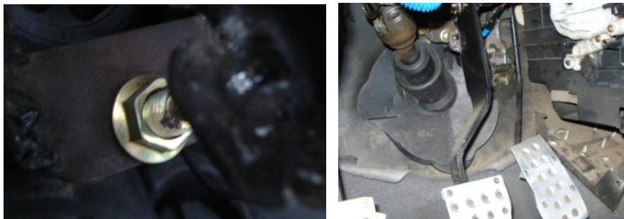
Figura 57: Interruptor del pedal instalado
