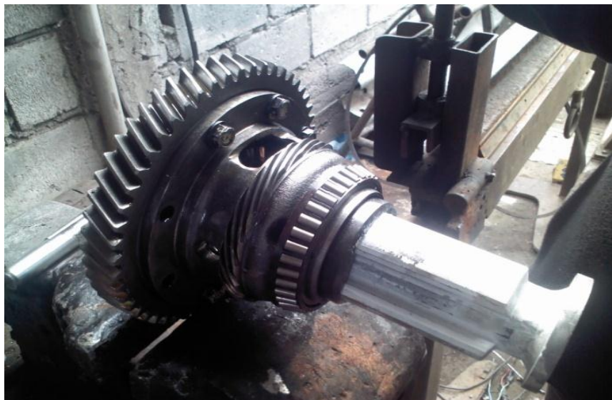
7 Figura 4.46.- Eje acoplado al grupo diferencial.
