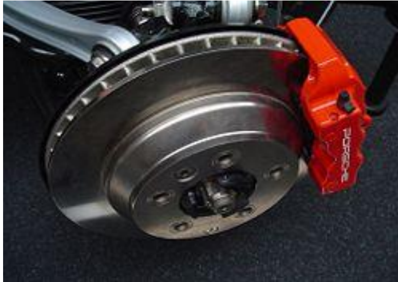
Figura 2.20.- Sistema de frenos de disco
