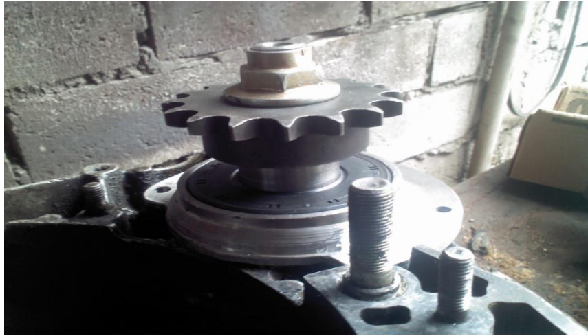
8 Figura 4.47.- Eje y piñón motriz de 16 dientes acoplados.
