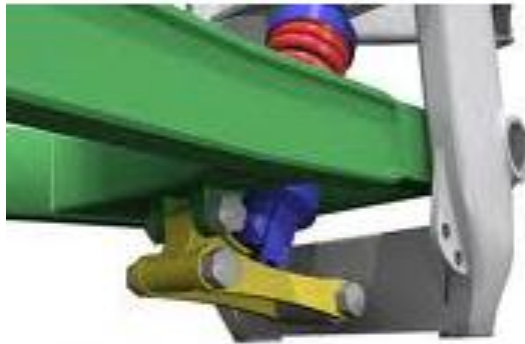
Figura 2.6- Suspensión posterior mono shock
