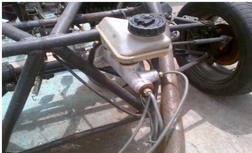
6 Figura 4.45.- Bomba y cañerías
