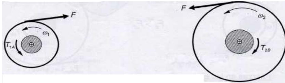
Figura 3.41.-Representación de fuerzas y torses en la cadena
