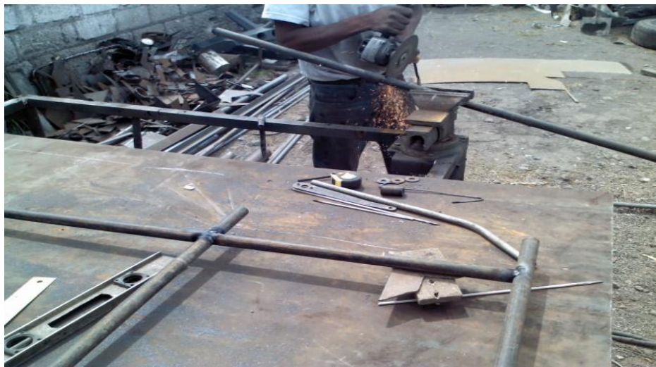
Figura 4.4.- Proceso de corte del tubo de acero estructural
