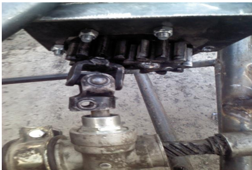
Figura 4.41.- Inversor de giro
