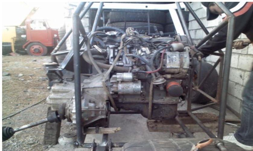
Figura 4.30.- Motor suspendido en el bastidor
