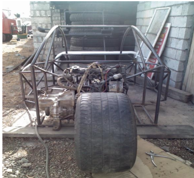
Figura 4.27.- Ubicación de motor en el prototipo
