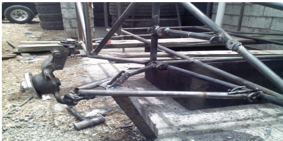
Figura 4.21.- Mesa inferior fijada al bastidor, manzana.
