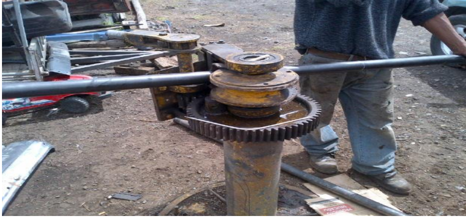
Figura 4.8.- Maquina manual dobladora de tubos
