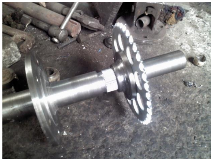
Figura 4.37.- Montaje catalina – eje
