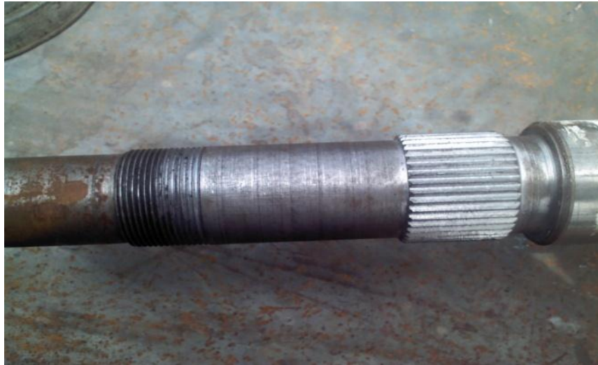
Figura 4.34.- Eje maquinado y estriado
