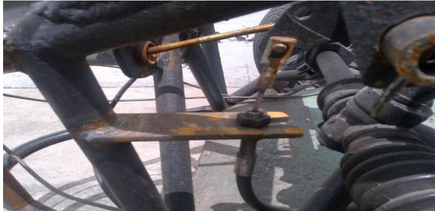
4 Figura 4.43.- Platina de 5mm de espesor de soporte para cable del embrague
