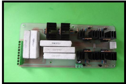
Figura 5. Placa de Potencia Principal
