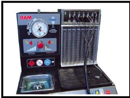
Figura 1. Banco de Pruebas Inyectores
