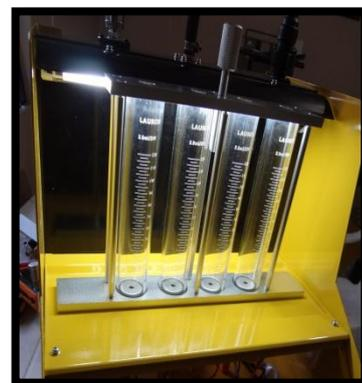
Figura 2. Banco de Inyectores Wi-Fi
