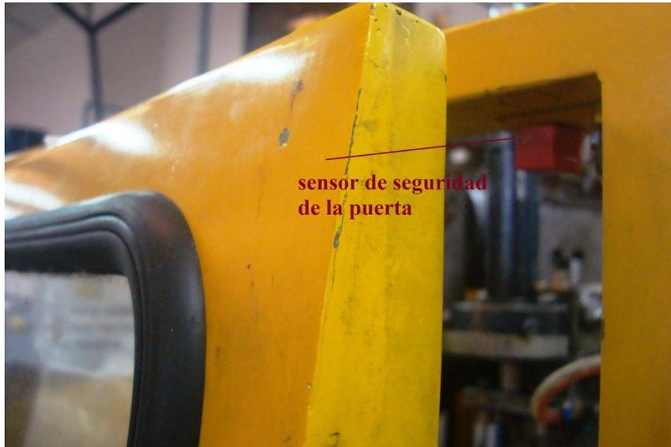
*Figura 3.11. Ubicación del sensor de seguridad*
