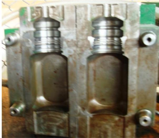
*Figura 1.12. Molde para el soplado de termoplásticos*
