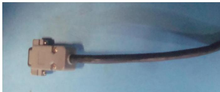
*Figura 3.1. Cable de comunicación PPI*
