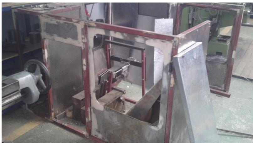
*Figura 3.4. (a). Proceso de construcción del tablero de control y potencia*
