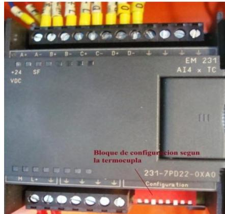
Figura 3.15. Módulo de entradas de termocuplas
