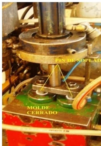
*Figura 1.13. Extrusión y soplado del termoplástico*
