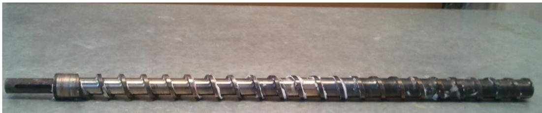
*Figura 1.6. Tornillo extrusor*
