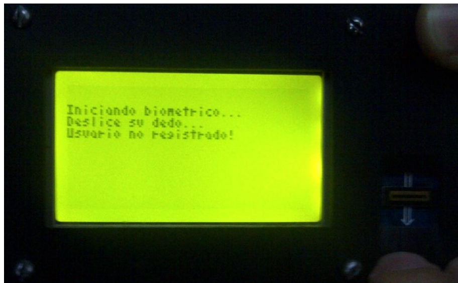
Figura 4.18. Foto presentación de la autenticación correcta de un usuario no registrado
