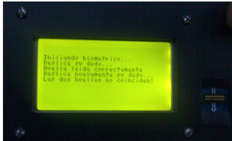
Figura 4.21. Foto presentación de un proceso de grabación fallido
