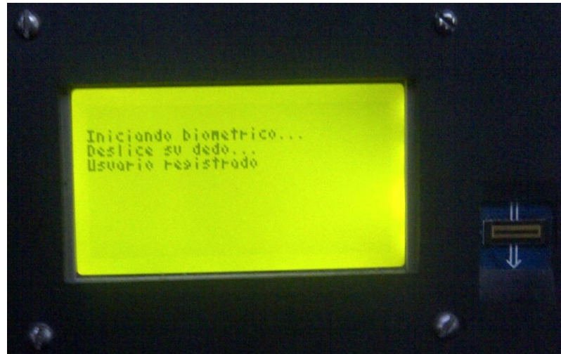
Figura 4.17. Foto presentación de la autenticación correcta de un usuario registrado
