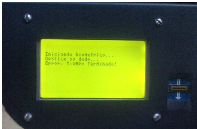
Figura 4.19. Foto presentación de un proceso de autenticación fallido por espera excesiva del lector
