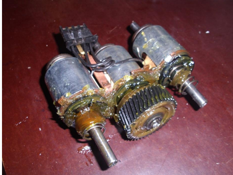
Figura 4.2. Embragues electromecánicos formados por solenoides
