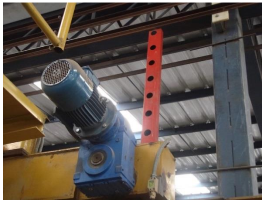
Figura 2.139: Estructura de los sensores inductivos para el puente grúa.
