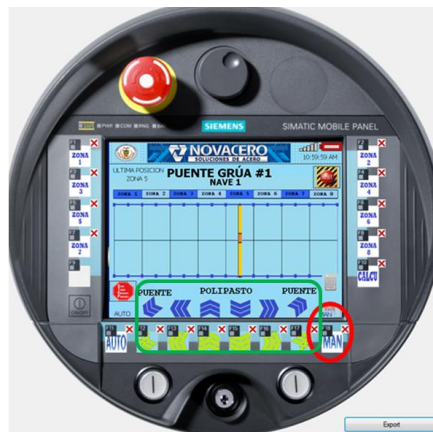
Figura 11: Movimientos manuales del puente grúa y polipasto
