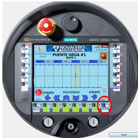
Figura 10: Movimientos manuales del puente grúa y polipasto.
