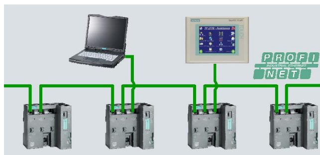
Figura 2.15: Interfase Profinet con switch de 3 puertos
