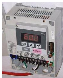
Figura 1.15: Variador de velocidad electrónico.
