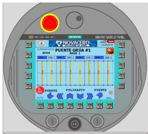
Figura 3.1: HMI Controlador del puente grúa
