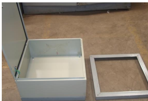
Figura 2.137: Bases del tablero de control para acoplar al puente grúa
