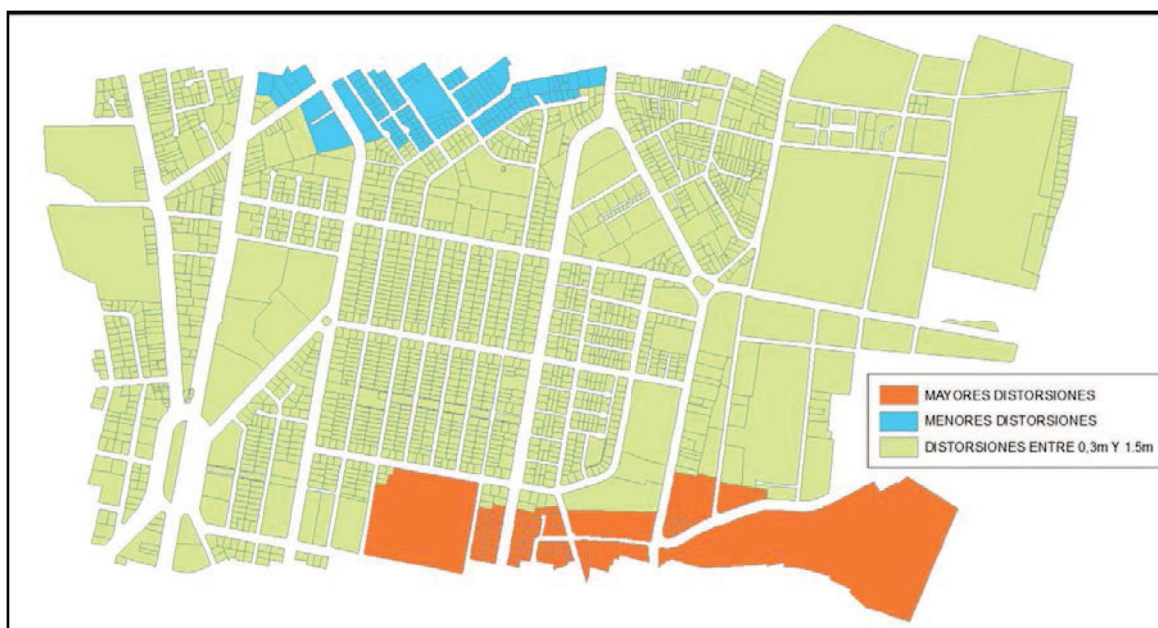
Figura. 4.1. Determinación de zonas con eventos extremos de distorsión en la zona de estudio utilizando el ajuste con mínimos cuadrados
