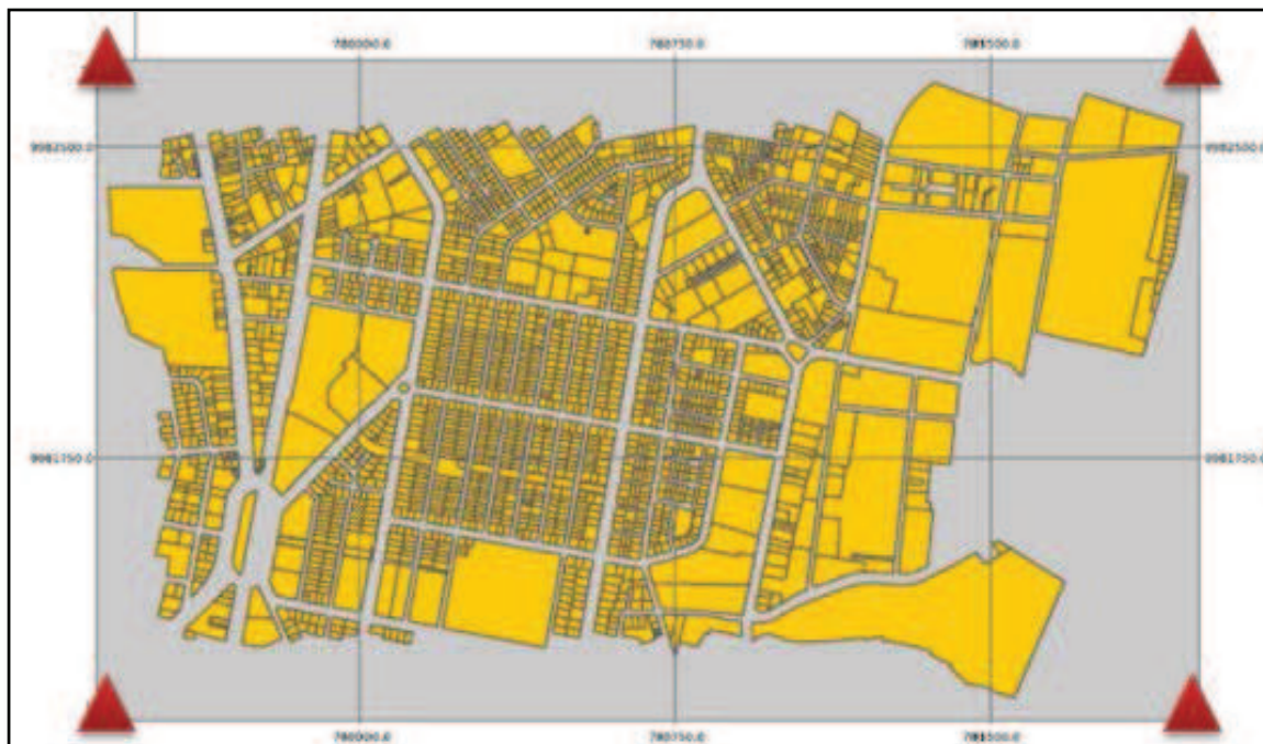
Figura. 3.1. Puntos seleccionados para el ajuste de mínimos cuadrados observados tanto en la cartografía de PSAD56 como en SIRGAS00
