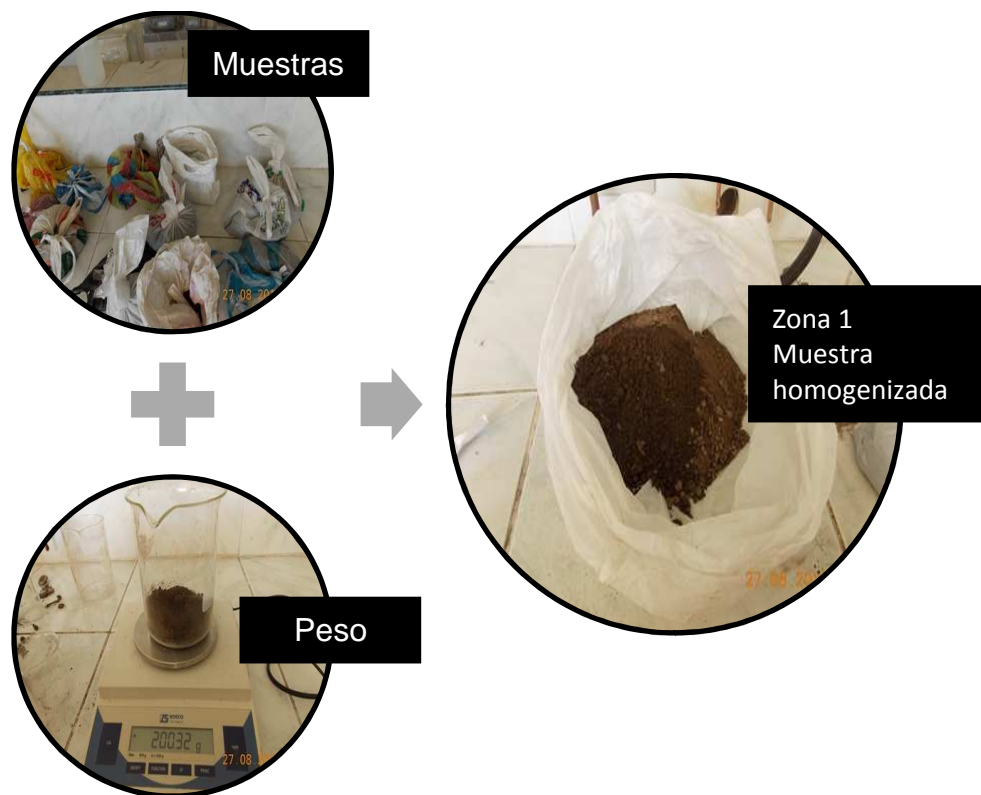
Imagen 3.19 Homogenización de las muestras
