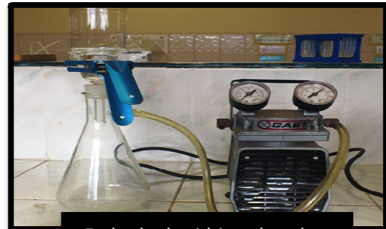
Embudo de vidrio colocado a un Kitasaco y bomba al vacío
