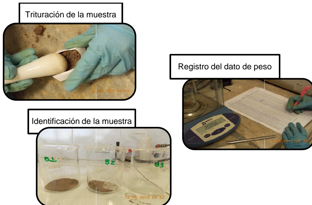
Imagen 3.5 Proceso de pesado de la muestra
