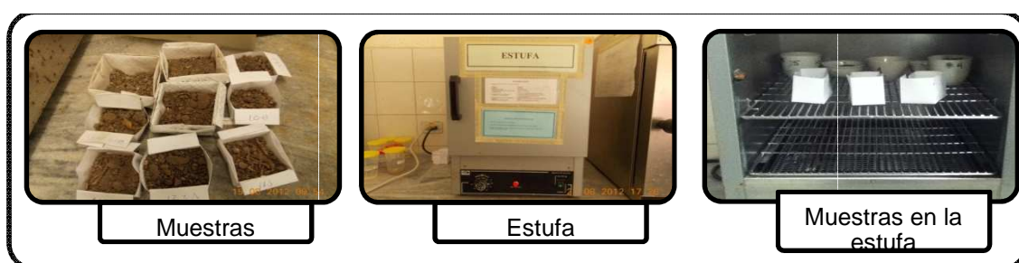
Imagen 3.3 Procesos de secado de las muestras
