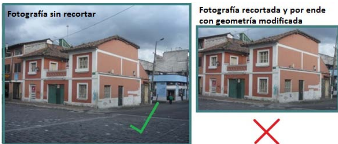
Figura 3.43. Comparación de la pérdida de geometría por recorte en la imagen.
