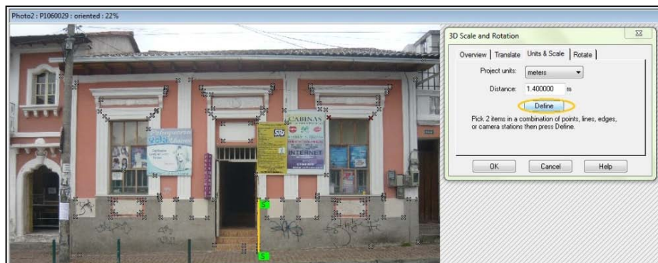
Figura 3.39. Escalado de la fachada.
