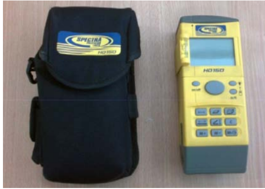
Figura 3.3. Distanciómetro láser Trimble Spectra Presicion Laser HD 150.
