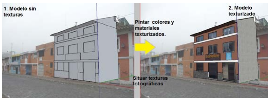
Figura 3.54. Ejemplo del uso de texturas fotográficas, colores y materiales texturizados en un modelo 3D.
