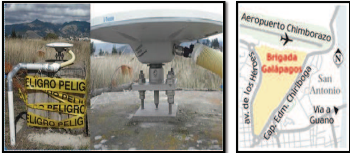
Figura 1.1 Monumento de la estación GNSS RIOP y croquis de ubicación
