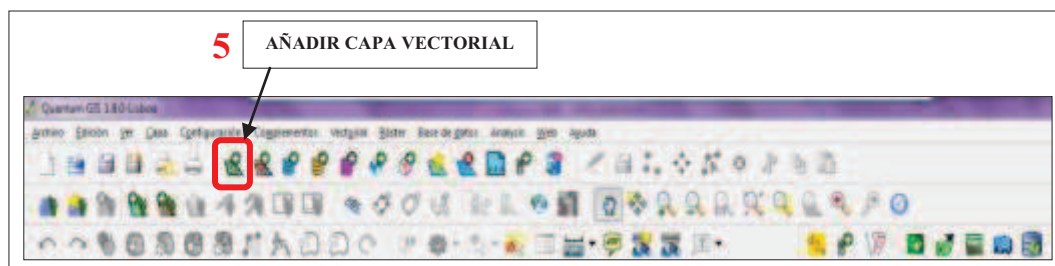
Figura No. 3.23: Adición de coberturas .shp
