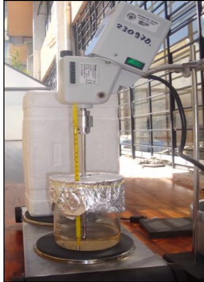
Figura 2.5 Mecanismo para la elaboración de la resina fenólica tipo resol.
