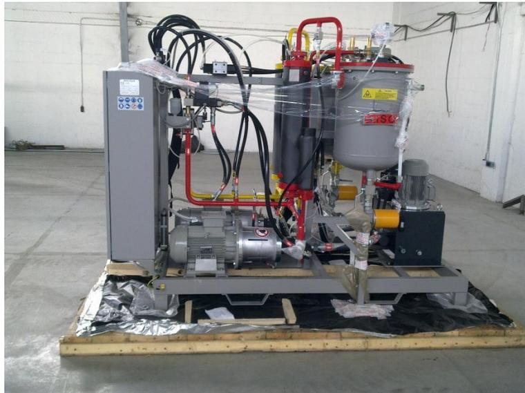
Esta máquina tiene un sistema hidráulico, un sistema oleohidráulico y un sistema neumático que tiene dos funciones principales: presurizar los tanques de químicos y accionar las válvulas de control.
