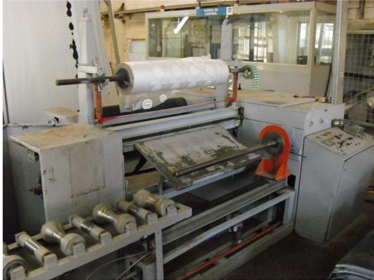
Su principal función, como su nombre lo indica, es expulsar los rollos una vez cortados que salen de la estación de laminación asfáltica de todo tipo, para pasar al proceso de rotulado. Consiste en un pistón neumático de doble efecto, cuyos consumos se detallarán más adelante junto al resto de actuadores.
