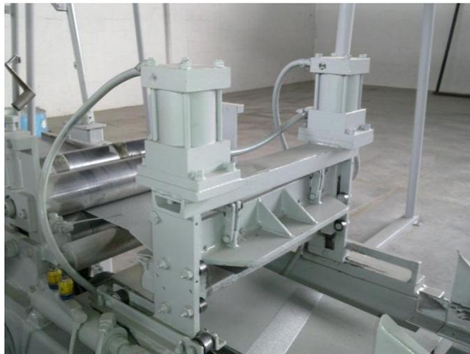
Estas máquinas cortan el fleje antes de ser laminado en secciones destinadas a la línea de canales y bajantes. El sistema neumático alimenta a dos pistones de doble efecto.
