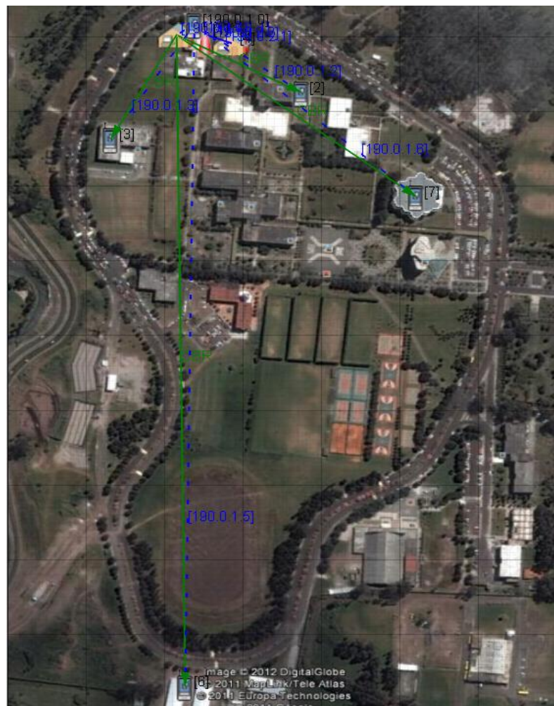
Figura 3. 2 Estructura de Red WiMAX ESPE
