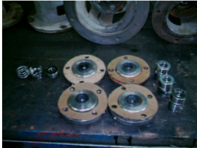
Figura. 3.34. Sellos mecánicos y rodamientos.
