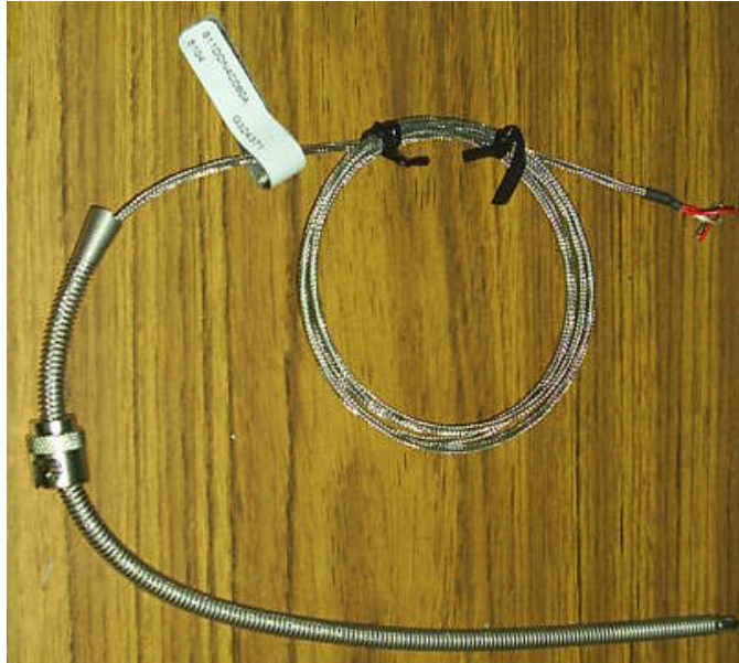
Figura. 2.15. Pt 100 Sensor de temperatura
