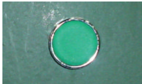
Figura. 3.20. Pulsador (simulador de entradas digitales)
