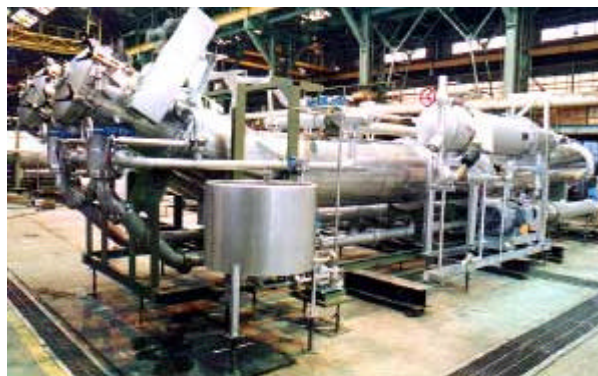
Figura. 1.1. Vista general jet tinturador de textiles
