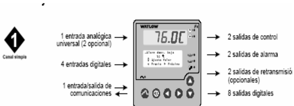
Figura 1.2. Entradas y salidas del equipo de un solo canal
