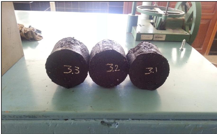
Figura 5.10: Briquetas ensayadas con 3% de asfalto.
