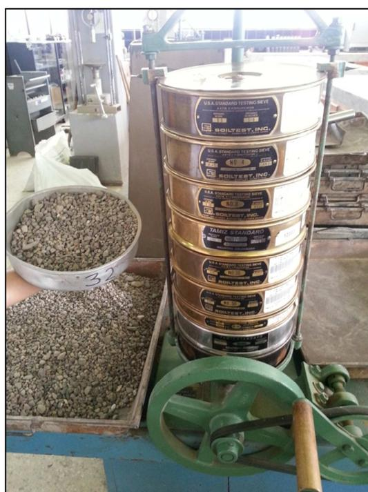
Figura 3.7: Tamizado del agregado pétreo.
