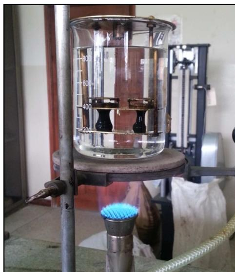
Figura 4.3: Culminación del ensayo de reblandecimiento.
