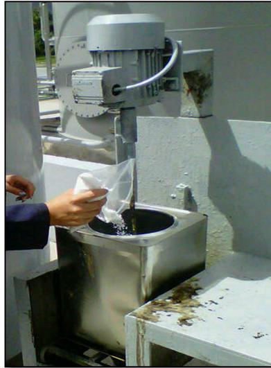
Figura 5.11: Adición del polímero SBS en el Asfalto.
