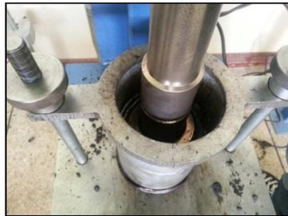
Figura 5.14: Compactación de la muestra para determinar contenido óptimo de agua.
