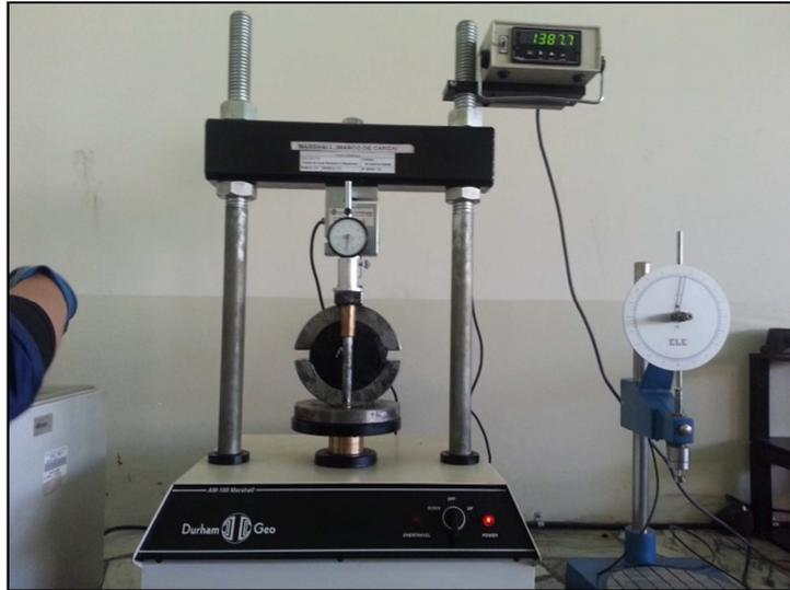
Figura 5.22: Ensayo de briqueta en la máquina de compresión Marshall.
