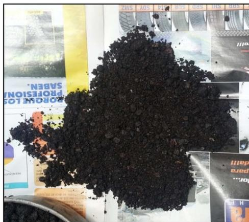
Figura 5.13: Muestra recubierta con emulsión.
