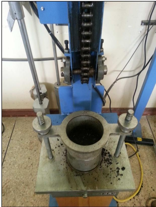
Figura 5.5: Briqueta en la compactadora.
