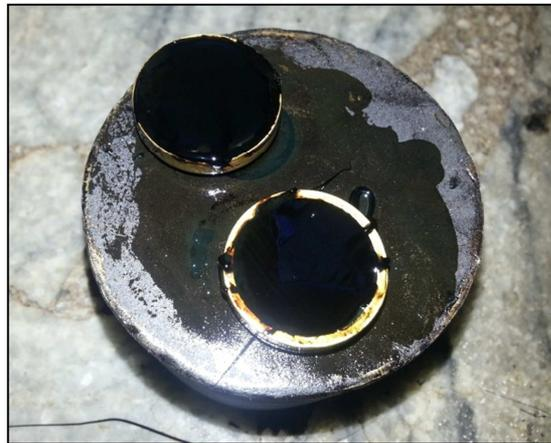
Figura 4.1: Anillos llenos de asfalto.
