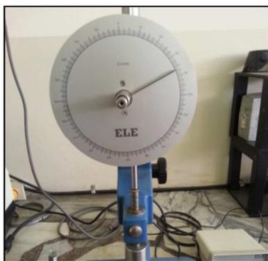
Figura 4.5: Toma de la lectura de penetración.
