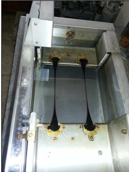
Figura 4.7: Realización del ensayo de ductilidad.
