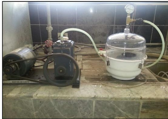
Figura 5.17: Saturación de la briquea en la bomba de vacíos.
