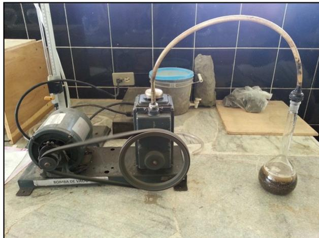
Figura 3.4: Extracción de burbujas de aire utilizando bomba de vacíos.
