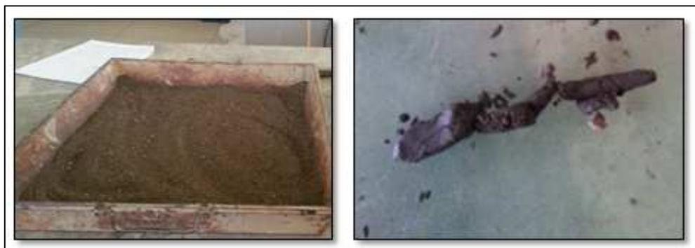
Figura 3.9: Ensayo Limite Plástico, material No plástico.
