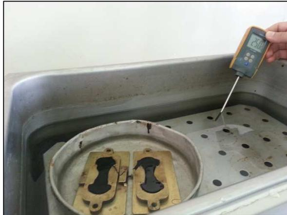
Figura 4.6: Muestra en los moldes a baño de agua a 25°C.
