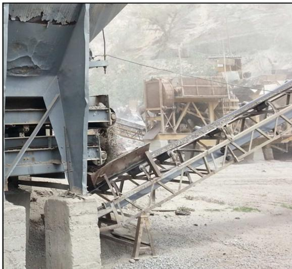
Figura 3.2: Banda transportadora de agregado pétreo.
