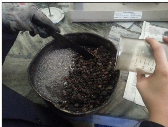
Figura 5.20: Adición del agua en el agregado.
