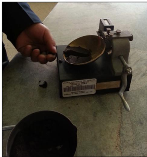
Figura 3.10: Ensayo en Casagrande.
