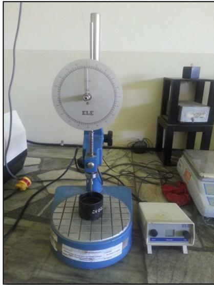
Figura 4.4: Muestra previa al ensayo de penetración.
