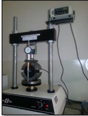
Figura 5.15: Ensayo de Marshall modificado.
