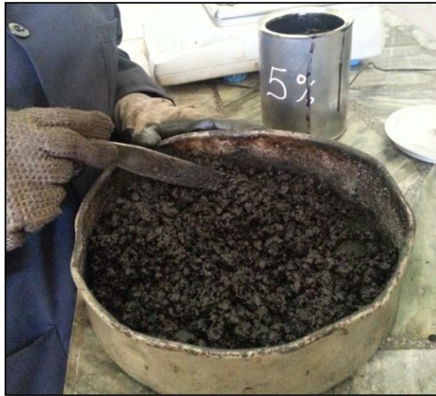
Figura 5.21: Mezcla de agregado, agua y emulsión con polímero.
