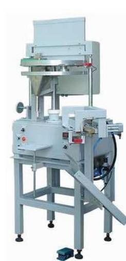
**Fig. 2.4** *Empacadora Semiautomática*<sup>4</sup>
