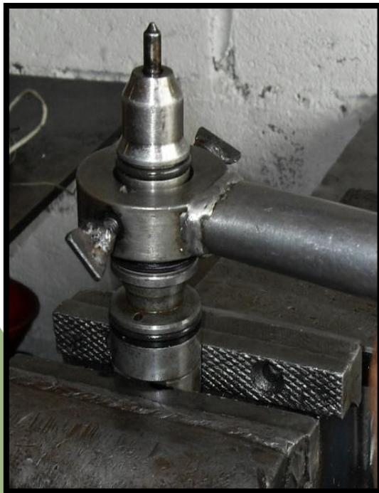
**Aflojar la camisa del inyector y desmontarla**
