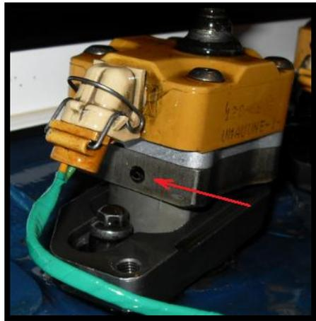
**INYECTOR EN BUEN ESTADO**
