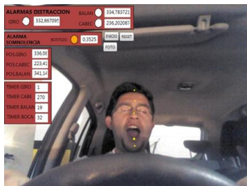
Figure 27. Alarma de somnolencia encendida, conducción real
