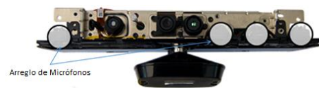
Figura 7. Arreglo de Micrófonos del Kinect
