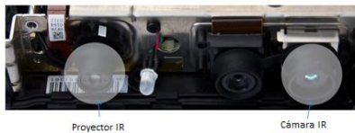
Figura 9. Elementos de la cámara de profundidad del Kinect
