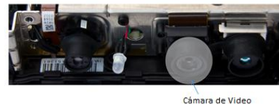
Figura 6. Imagen interna de la Cámara de Video del Kinect
