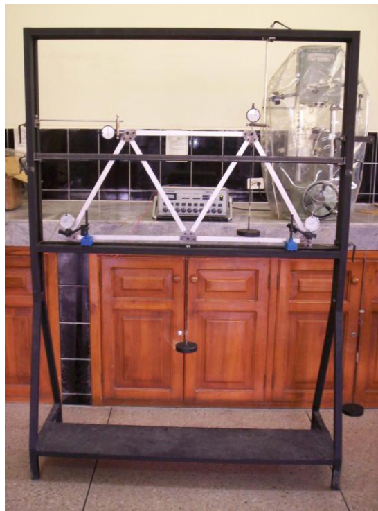
Figura 4.55 Armadura y elementos anexos ensamblados en bastidor
