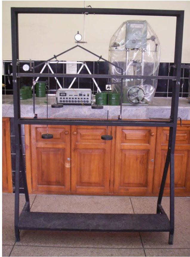
Figura 4.62 Pórtico y elementos anexos ensamblados en bastidor
