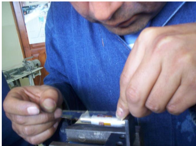
Figura 4.40 Colocación de galga y lámina sobre superficie
