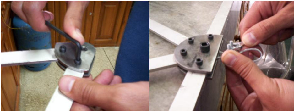
Figura 4.43 Ensamblaje de placas con elementos y ganchos de la armadura
