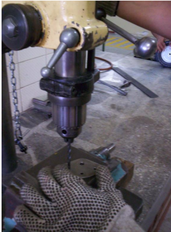
Figura 4.8 Perforación de agujeros en taladro
