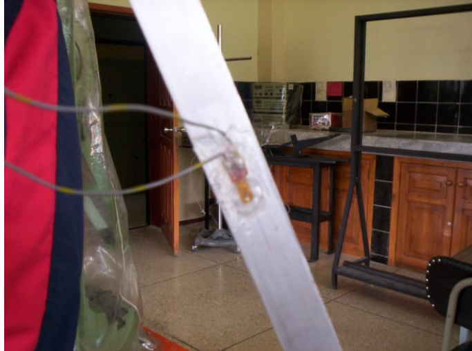
Figura 4.42 Galga extensiométrica en elemento de la armadura
