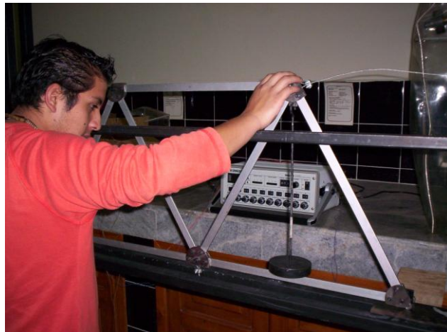
Figura 4.51 Acople de armadura en apoyos y colocación de porta pesas
