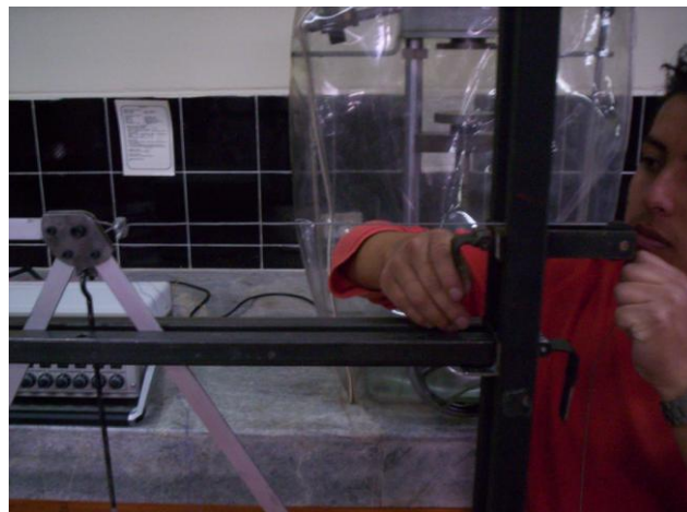
Figura 4.52 Ensamble de soporte, polea y nivelación horizontal de cable de gancho
