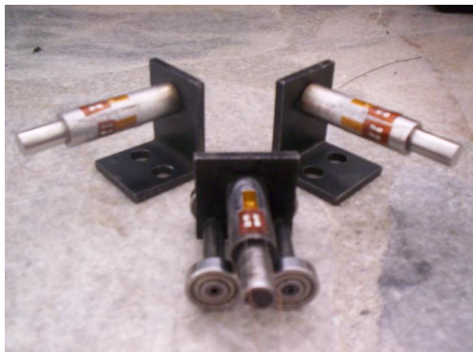
Figura 4.41 Galgas extensiométricas en apoyos tipo pasador y apoyo tipo rodillo
