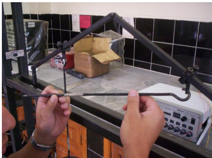
Figura 4.58 Colocación de porta pesas
