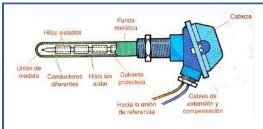
Figura 2.30 Partes de una Termocupla Industrial.
