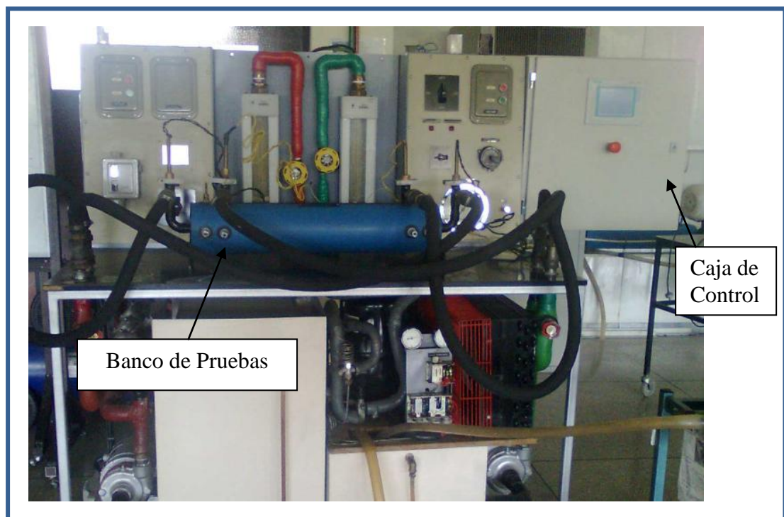
Figura 4.28 Ubicación de Caja de Control en el Banco de Pruebas de Intercambiadores de calor.
