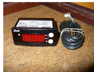
Sistema de control electrónico con microprocesador digital con gestión para control de temperatura, descarche, termómetro, operación del evaporador y compresor, incluye display luminoso y dos sondas EKC101
