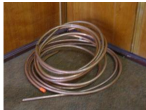
Tubería flexible de 7/8" y 1/2".
