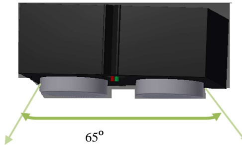
Figura III-10: Cobertura Horizontal del Sensor Ultrasónico
