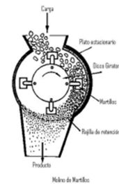
Figura. 4. Molino de Martillos para Trituración de LFC's [4]
