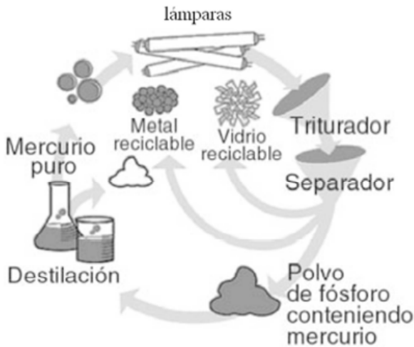
Figura. 3. Método Trituración para Reciclaje de LFC's [3]
