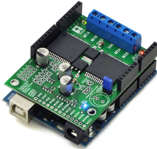
Figura 3.8 Placa driver Pololu VN1601 montada sobre un Arduino UNO.
