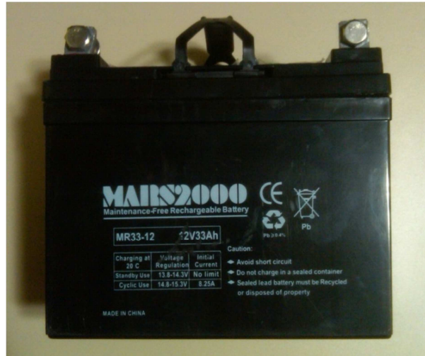
Figura 3.75 Batería MARS2000 MR33-12 sellada de 12V33Ah para los motores.
