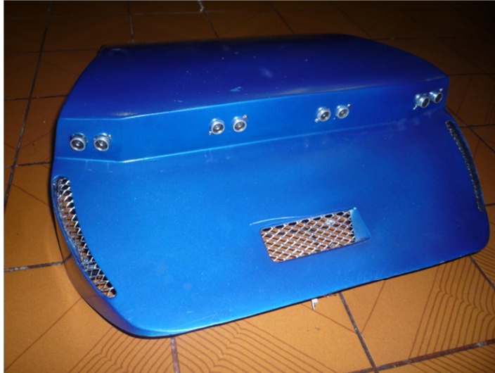
Figura 5.20 Montaje de sensores delanteros.
