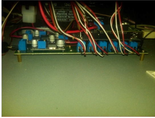
Figura 5.43 Unión de la placa electrónica a la plancha.
