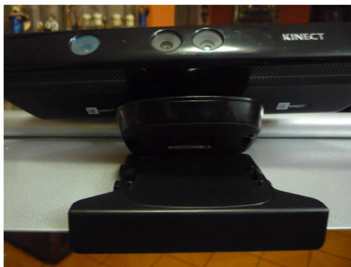
Figura 5.35 Sistema de agarre del clip de montaje al Kinect.
