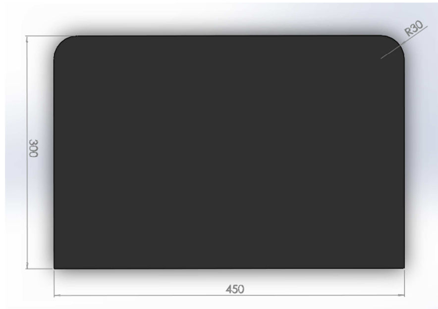
Figura 5.13 Forma y dimensiones de la plancha para la computadora portátil.
