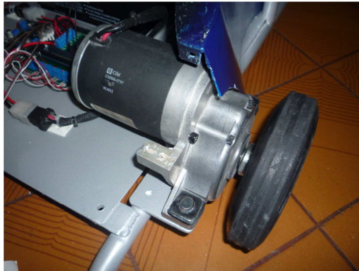
Figura 5.22 Resultado ensamble del acople de motores.
