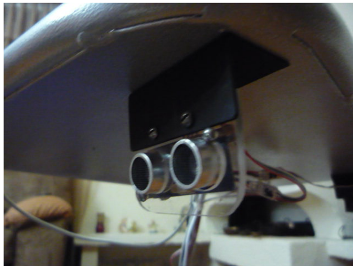
Figura 5.39 Unión de los sensores traseros a la plancha.
