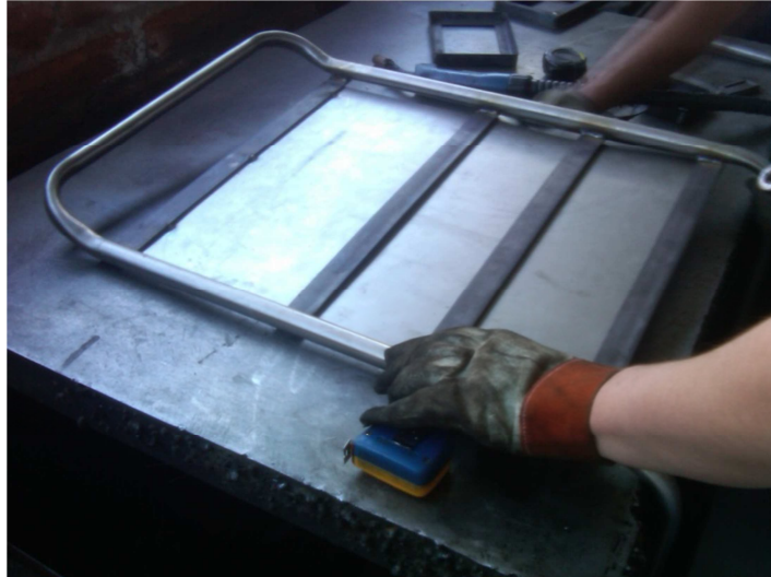
Figura 5.30 Fijación de la plancha inferior.
