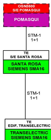
**Figura 4.5** Configuración Lineal a nivel STM-1
