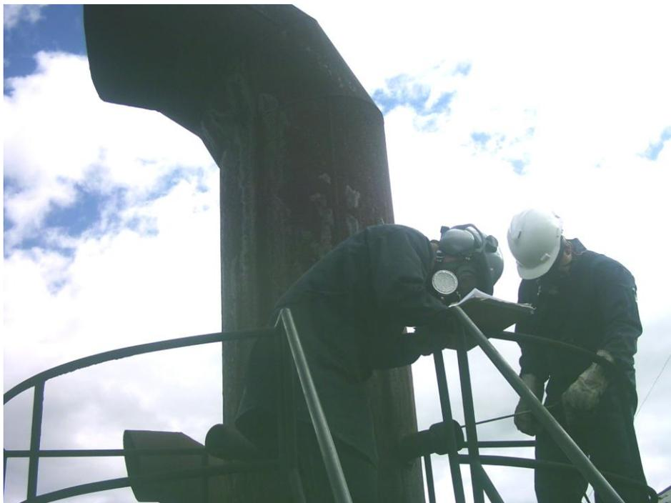
**Fotografía 5.9 Toma de datos con equipo TESTO 350 M/XL CONTROL UNIT en la chimenea del motor Nro. 4**
