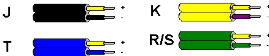
Figura 6.2 Códigos de color de las termocuplas o termopares.
