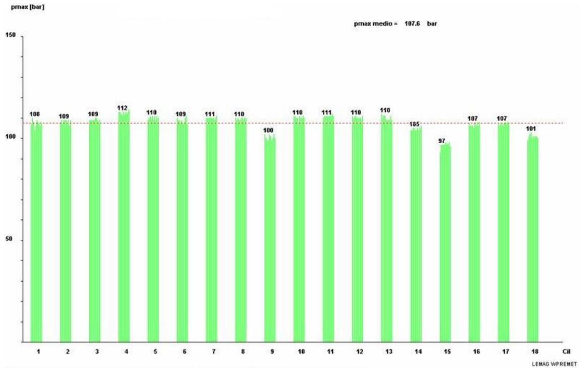
**Figura 4.10** Presión máxima, todos los cilindros y todas las carreras.
