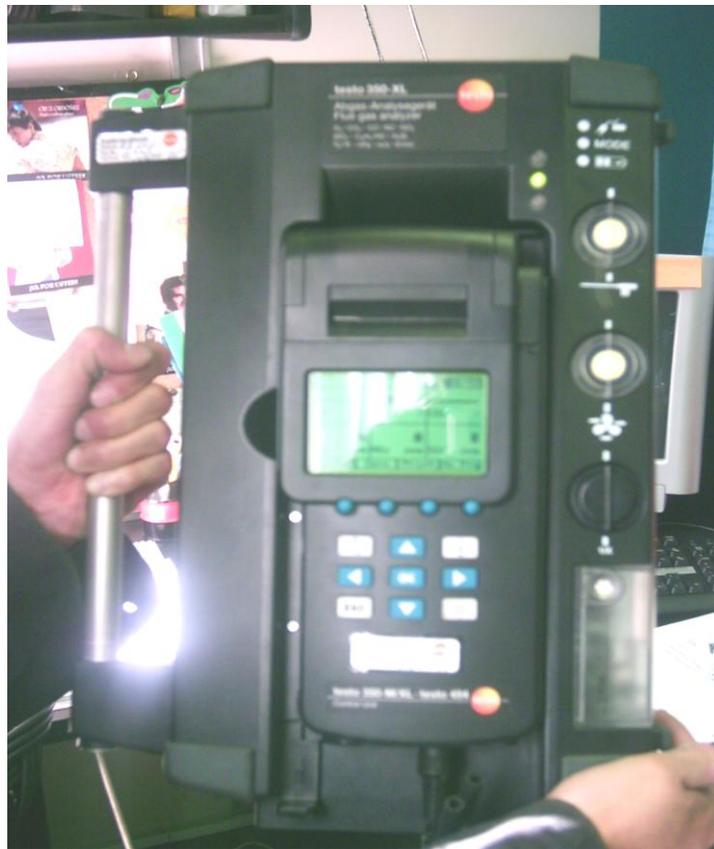
**Fotografía 5.5** Equipo de medición de gases de combustión.
