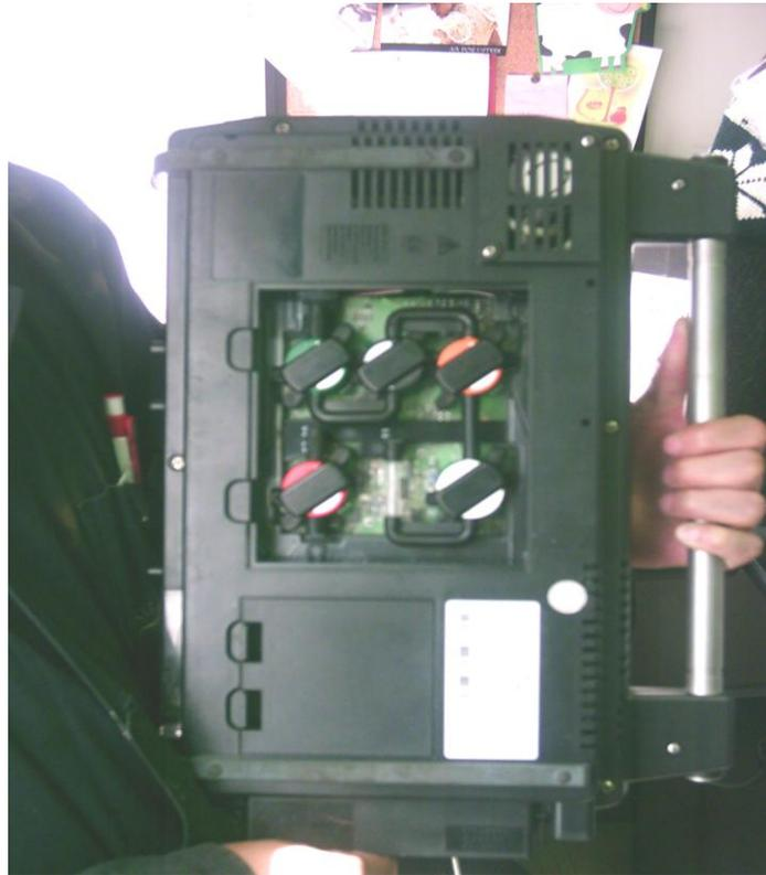
**Fotografía 5.6 Celdas Electro – Químicas del equipo: TESTO 350 M/XL CONTROL UNIT.**
