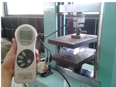
Figura 5. Ensayo de Compresión de botellas PET
