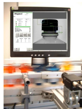
Figura 3. Inspección de nivel de líquido y sellado de botellas utilizando software de Visión Artificial.
