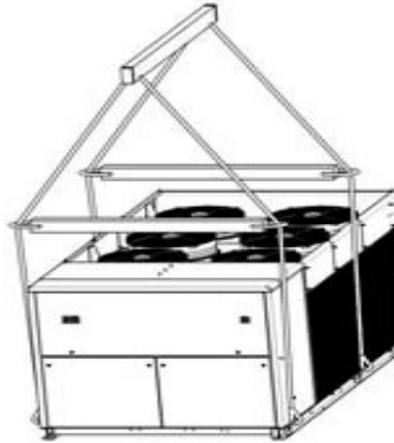
Figura 4. 2 Levantamiento del Chiller
