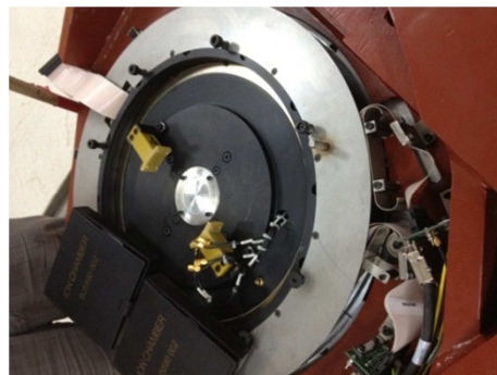
Figura 4. 24 Instalación de las Cámaras de Ionización
