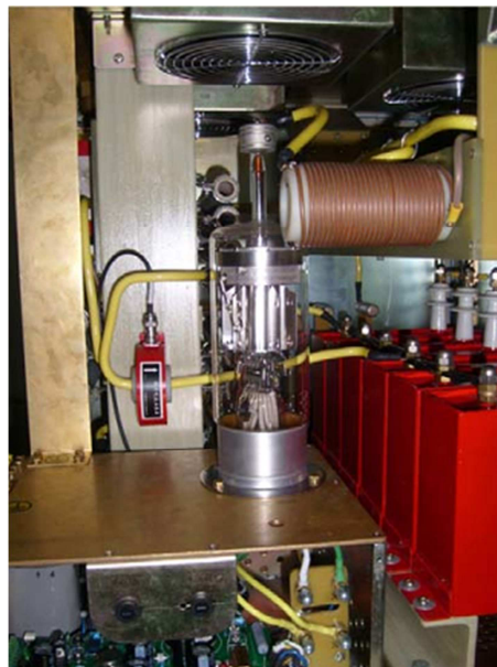
Figura 4. 39 Thyatron dentro del Modulador
