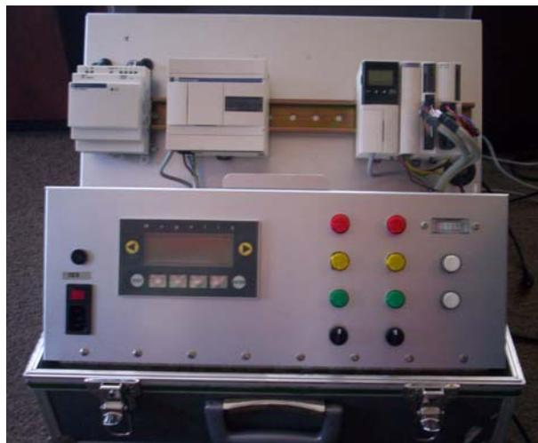
Figura 7.1. módulo 5 Automatismo y HMI
