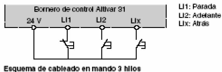
Figura 2.29.Mando 3 hilos Fuente: TELEMECANIQUE, Catálogo 2004
