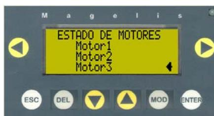
Motor1: Campo de lectura de tipo lista enumerada conectado a %MW6; este registro corresponde a la señal de activación o paro del motor 1.
