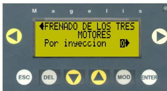
Por inyección: Vínculo de tipo mando impulsional conectado al bit %M18, que da la orden de frenar los motores por inyección
