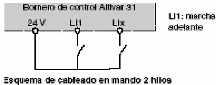
Figura 2.28.Mando 2 hilos Fuente: TELEMECANIQUE, Catálogo 2004
