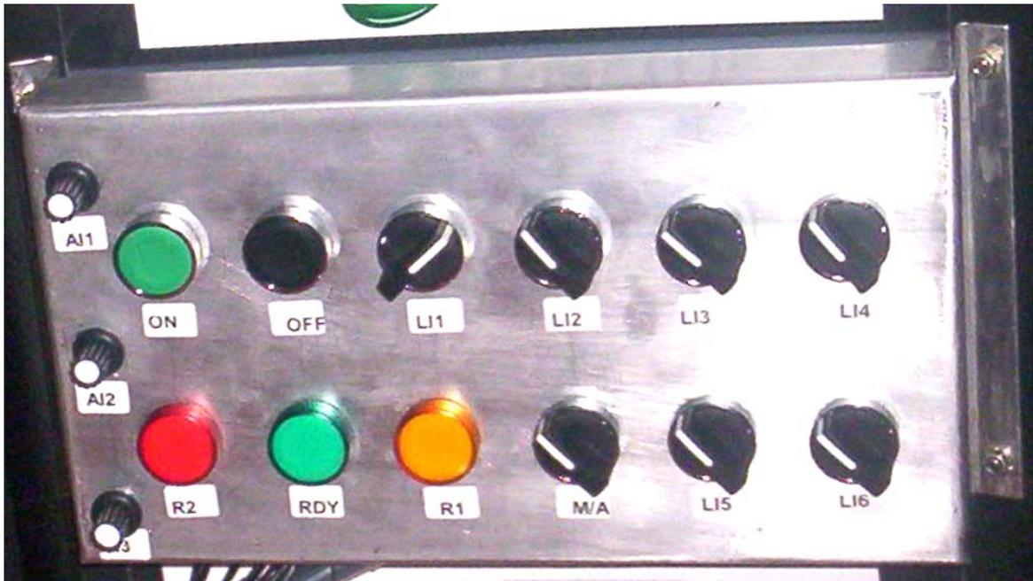
Figura 3.7 : Bloque de entrada y supervisión
