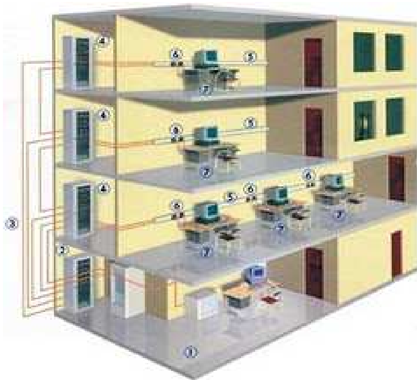
Figura 2.1: (Componentes de un sistema de cableado estructurado)
