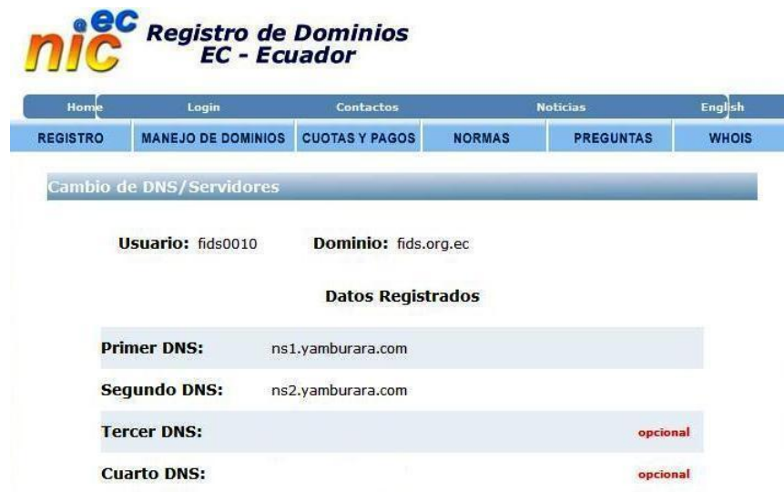
Ilustración 25. Direccionamiento DNS Fundación FIDS original
