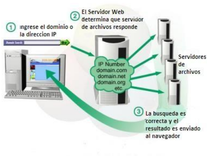
Ilustración 6. El funcionamiento de un sitio web
