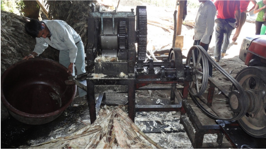
Imagen N° 3 (Proceso de molienda en el trapiche mecánico)
