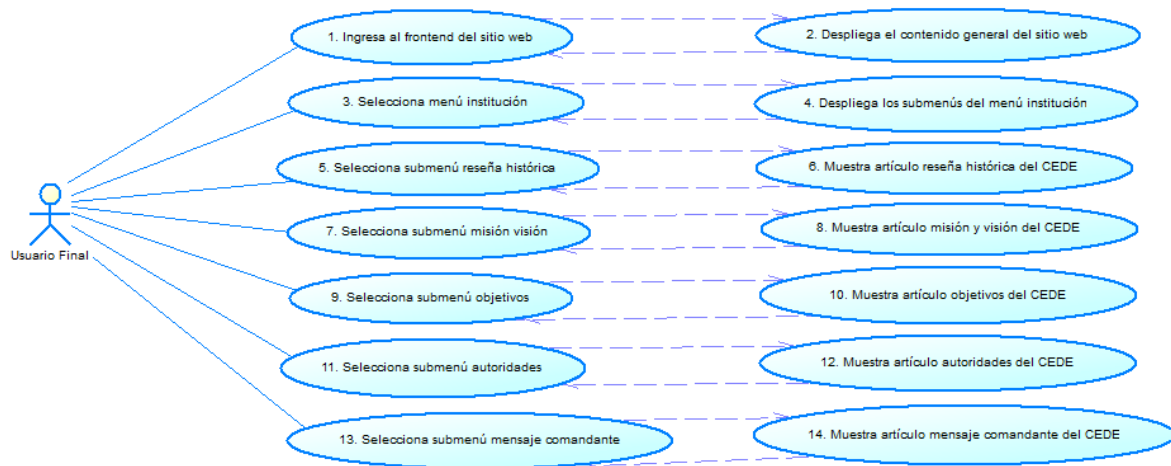
Figura 3.5: Diagrama de Caso de Uso para el Usuario Final módulo Frontend del Sitio Web (menú Institución)
