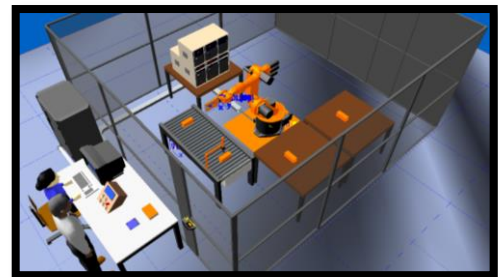
Figura 2: Celda de manufactura con una configuración en anillo.
