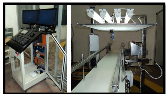
Figura 5: Estación de control de calidad.
