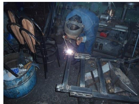
Figura 4 Ensamblaje por soldadura del bastidor
