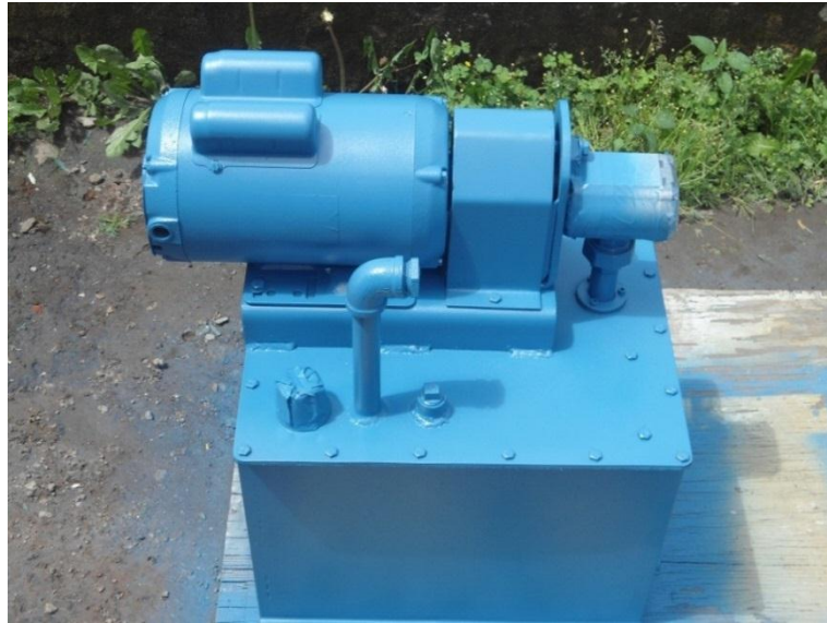
Ensamblaje y pintura de la central hidráulica
