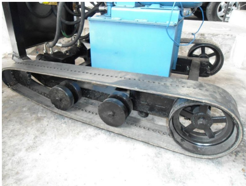
Montaje de la banda de rodadura
