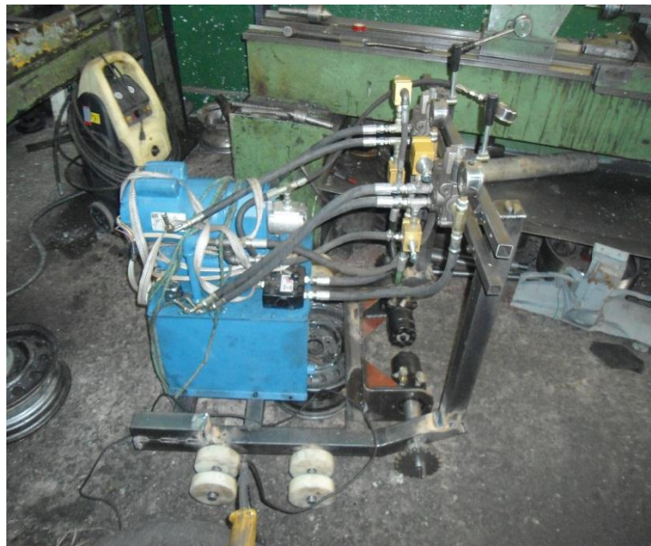
Montaje de la central hidráulica y válvulas al bastidor
