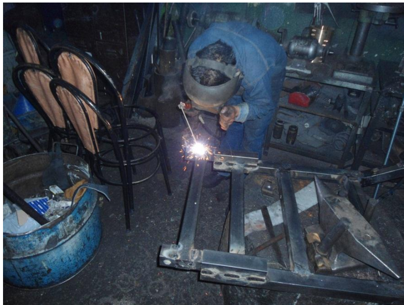
Ensamblaje por soldadura del bastidor
