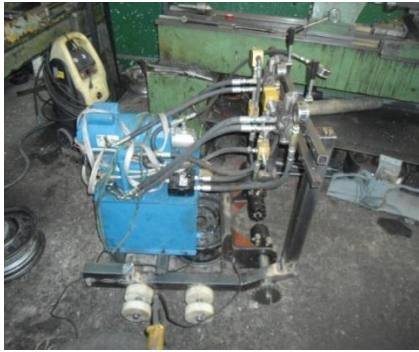
Figura 6 Montaje de la central hidráulica y válvulas al bastidor
