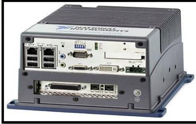
El EVS está sincronizado con el Bloque Terminal de E/S (NI Vision I/O), para habilitar entradas y salidas digitales, permitiendo una comunicación con el PLC de la banda transportadora y obteniendo una inspección más compleja y de más alta velocidad.
