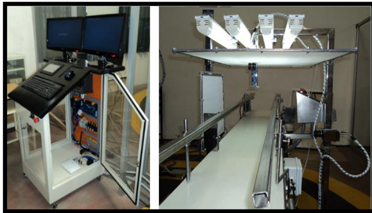
Figura 2.45: Estación de control de calidad.
