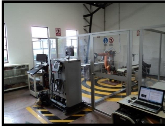
Figura 2.49: Celda de manufactura con vallas de protección.
