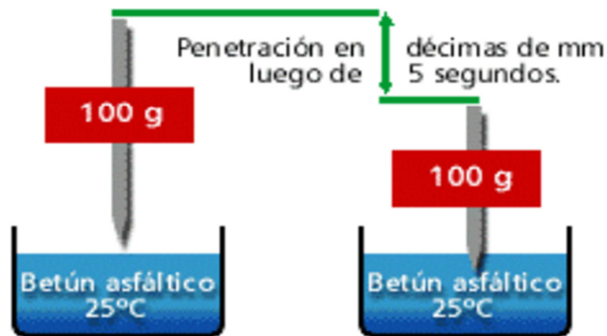
Figura 5.18 Ensayo de penetración
