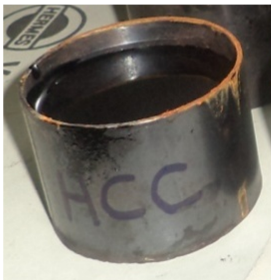
Figura 5.22 Muestra de Asfalto a ensayarse
