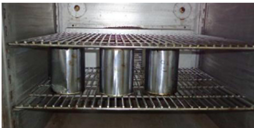
Figura 5.23 Recipientes de asfalto al Interior del Horno
