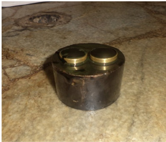
Figura 5.27 Moldes de muestra para ensayo
