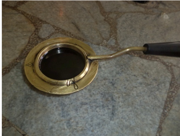
Figura 5.33 Vertido de muestra de asfalto en Vaso Abierto Cleveland
