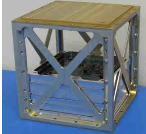
Figura 2.1: Armadura de la estructura del CubeSat XI-V
