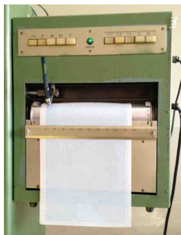
Figura 5.9: Máquina de ensayos universales graficando curva
