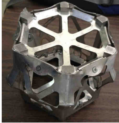
Figura 8.11: Fallas prototipo Hexasat (temperatura -77.8\text{ }^{\circ}\text{C} )
