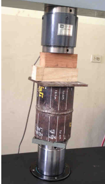
Figura 6.2: Proceso de práctica con la máquina MTS 810-14-2
