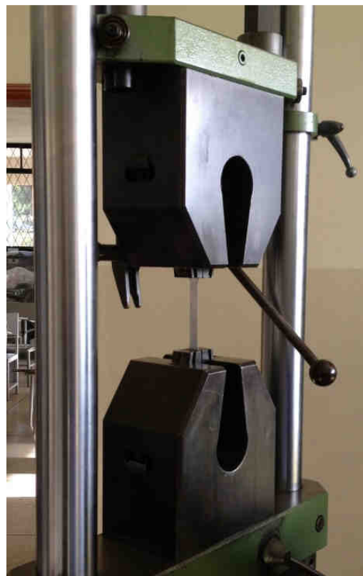
Figura 5.7: Ensayo de tracción en probetas para placas de aluminio
