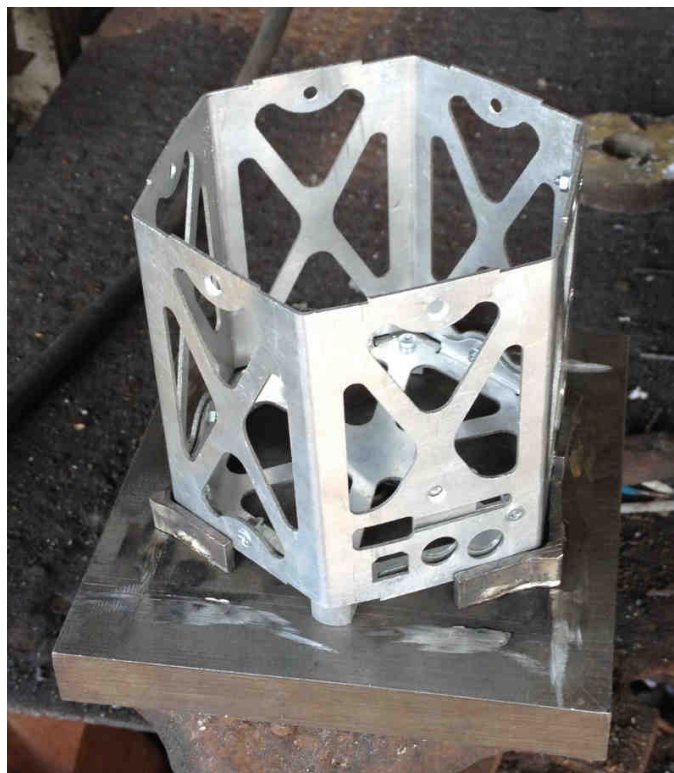
Figura 6.1: Accesorio fabricado para ensayo de fatiga
