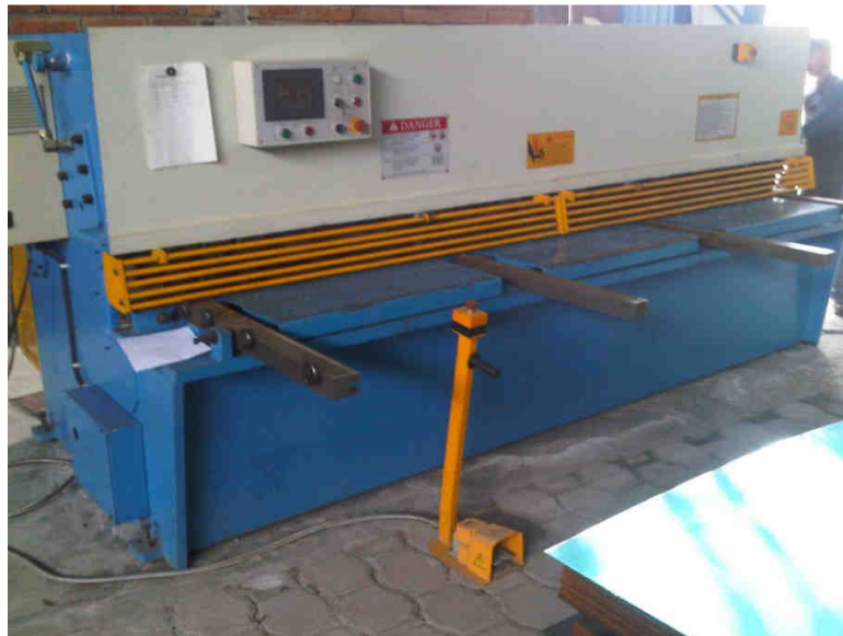
Figura 4.1: Cizalla eléctrica de precisión empleada para los cortes del material
