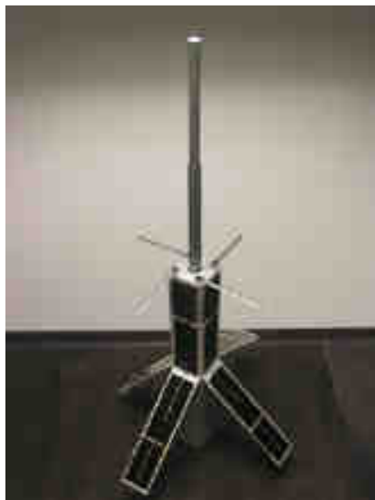
Figura 2.6: Estructura desplegada de QuakeSat diseñado por la universidad de Stanford
