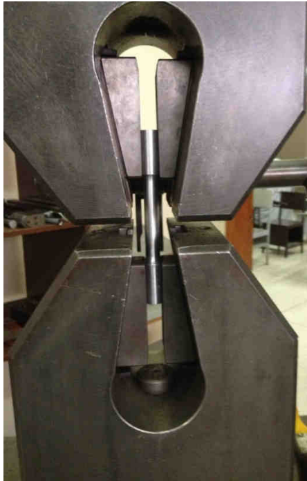
Figura 5.8: Ensayo de tracción en probetas para barras de aluminio
