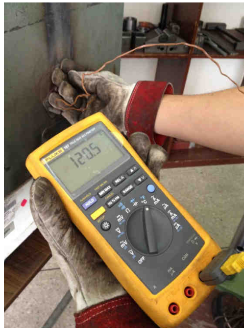
Figura 7.2: Comprobación de temperatura en horno de mufla
