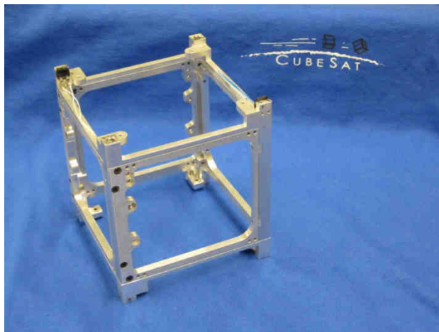
Figura 2.4: Estructura de un picosatélite CubeSat
