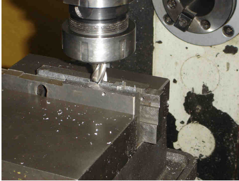
Figura 4. 10: Operación final del material para construcción de contactos
