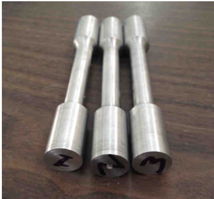
Figura 5.4: Probetas de aluminio dúctil para barras
