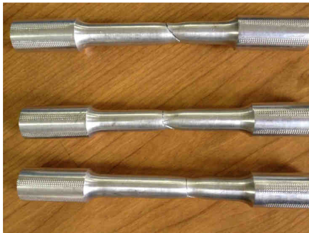
Figura 5.11: Probetas cilíndricas después de rotura
