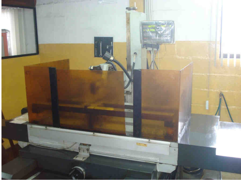
Figura 4.5: Máquina de corte de hilo por electroerosión CNC
