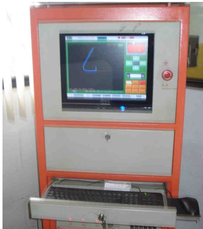
Figura 4. 6: Panel de control para ingreso de datos y operación para corte de aluminio con hilo por electroerosión CNC
