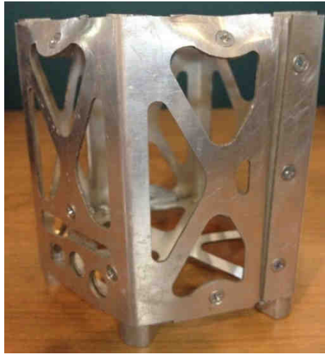
Figura 8.13: Fallas prototipo Hexasat (temperatura 120 °C)
