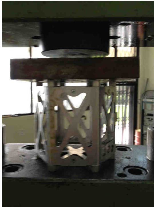
Figura 5.16: Prototipo estructural Hexasat sometido a ensayo de compresión
