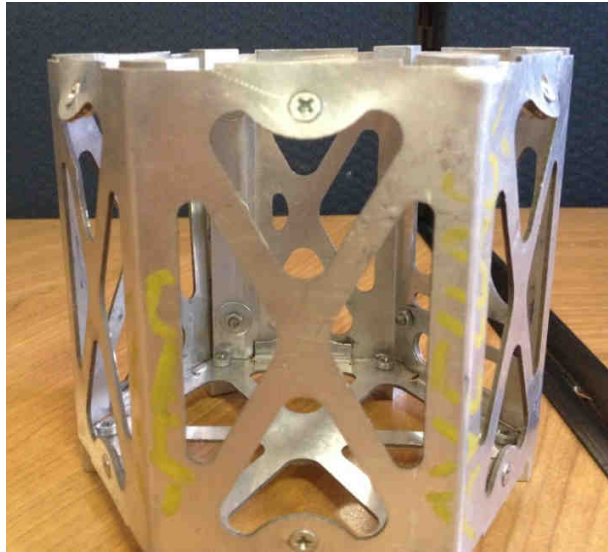
Figura 5.33: Deformación de pestañas superiores, ensayo de compresión prototipo estructural Hexasat
