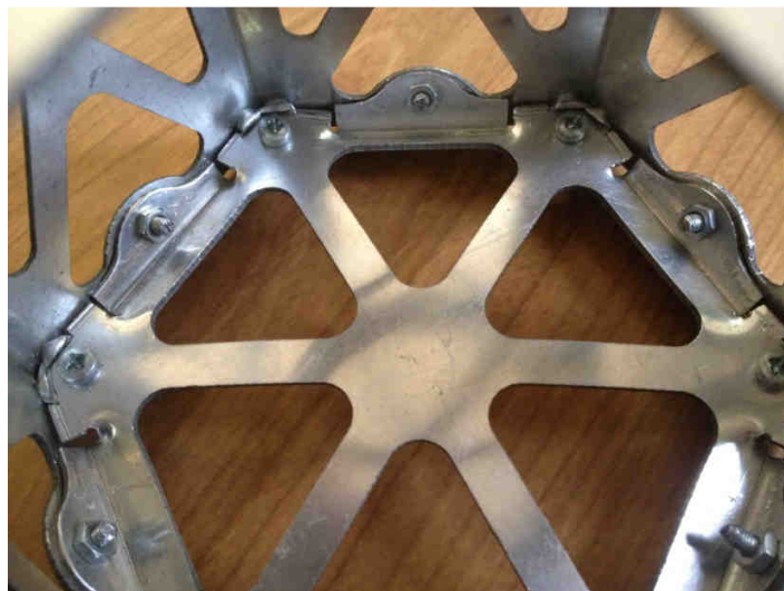
Figura 5.32: Cedencia en los apoyos de los dobles, ensayo de compresión prototipo estructural Hexasat
