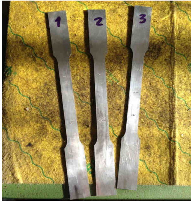
Figura 5.3: Probetas de aluminio 1050 para placas
