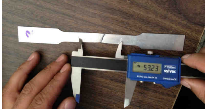
Figura 5.10: Probeta plana después de rotura
