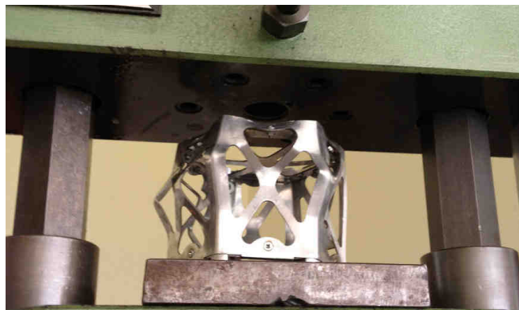
Figura 7.18: Deformación de columnas del prototipo
