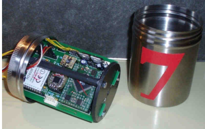
Figura 3.2: Vista interior de un Cansat
