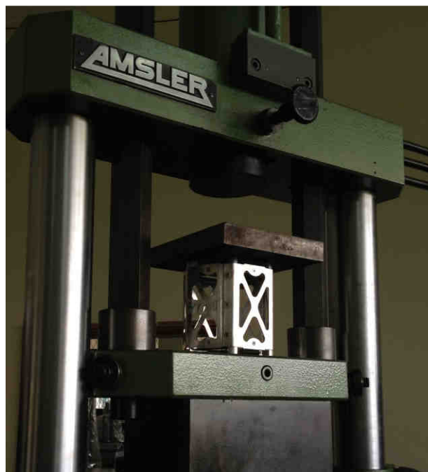
Figura 5.15: Prototipo estructural Hexasat sometido a ensayo de compresión
