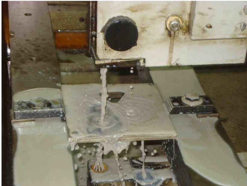
Figura 4.7: Corte de pedazos de aluminio con hilo por electroerosión CNC
