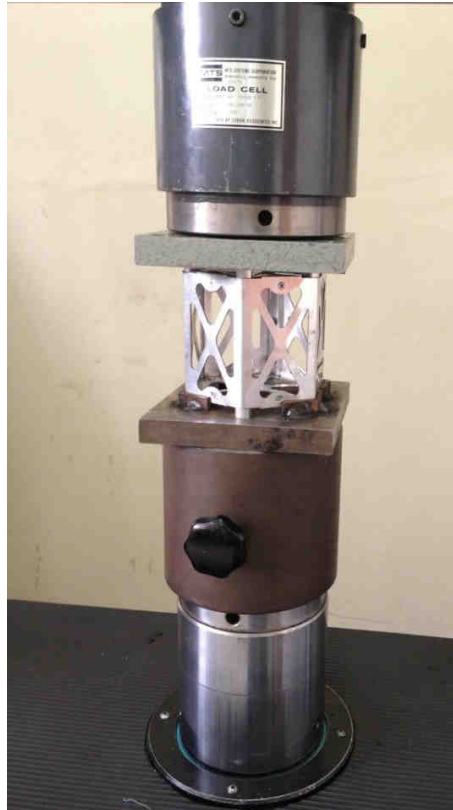
Figura 6. 3: Prototipo Hexasat listo para ensayo de fatiga
