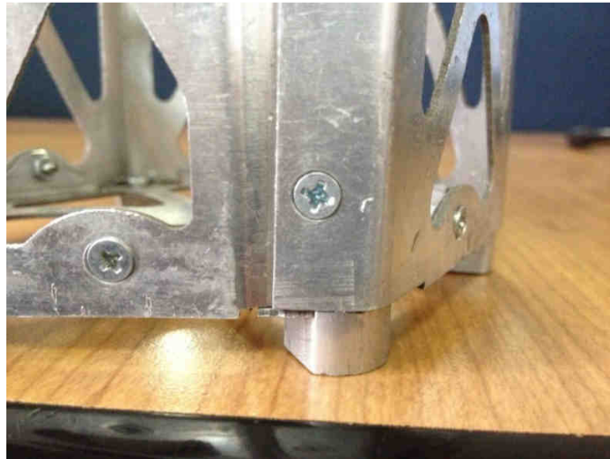
Figura 8.9: Ejemplo de durabilidad en orificios Hexasat
