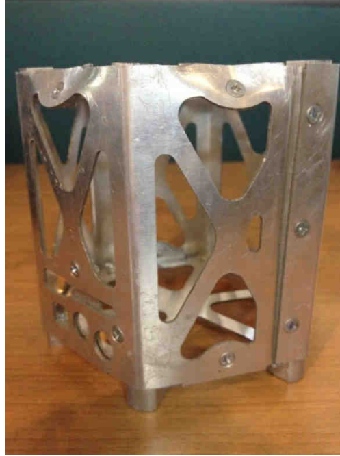
Figura 7.16: Deformación en dobleces y pestañas
