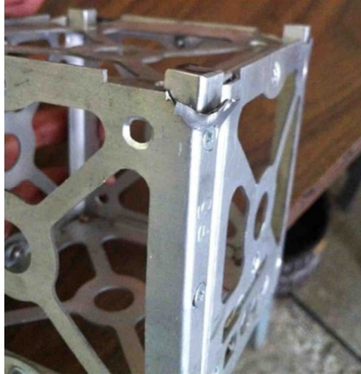
Figura 8.7: Fallas del prototipo CubeSat
