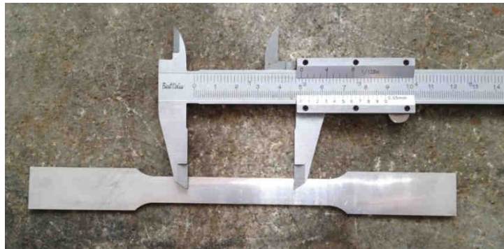
Figura 5.5: Preparación de probetas
