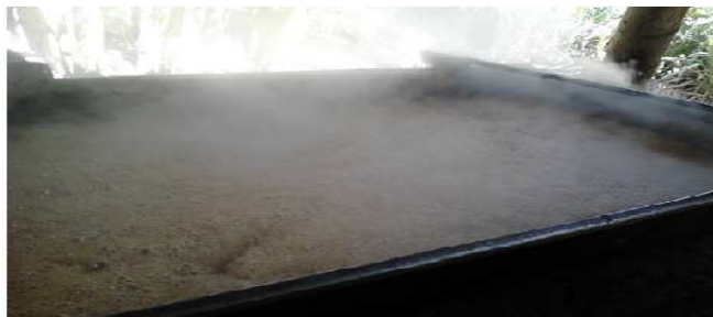
Figura 2.4. Evaporación del agua que contiene el jugo de la caña
