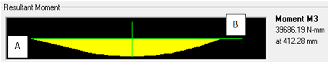
Figura 3.25 Diagrama Momento Flector Plano YZ (SAP 2000)
