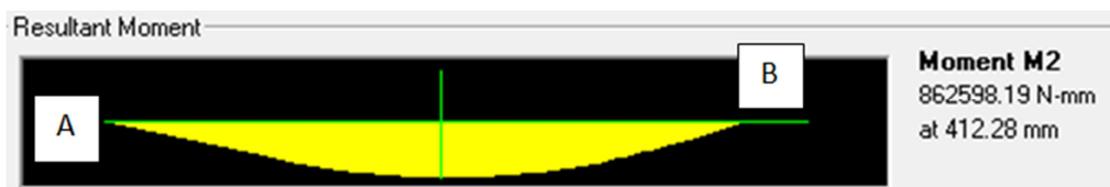
Figura 3.27 Diagrama Momento Flector Plano XZ (SAP 2000)
