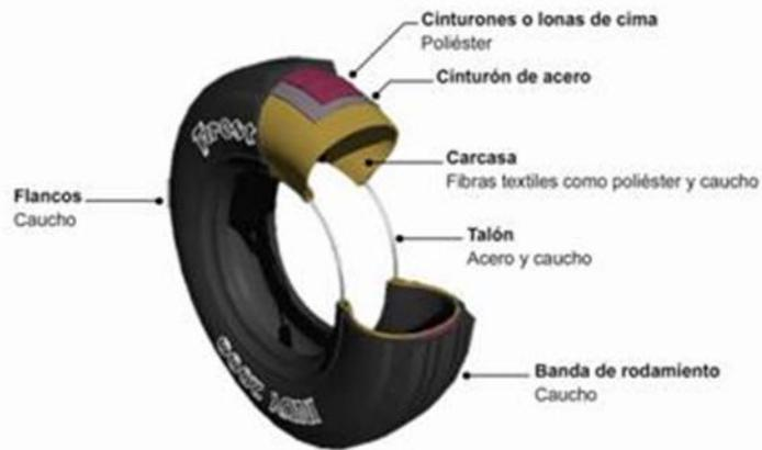
**Fig. 2.2 Corte lateral partes de una llanta.**
