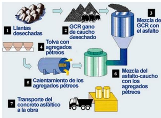
**Fig. 3.4 Proceso del asfalto integrado con caucho reciclado**
