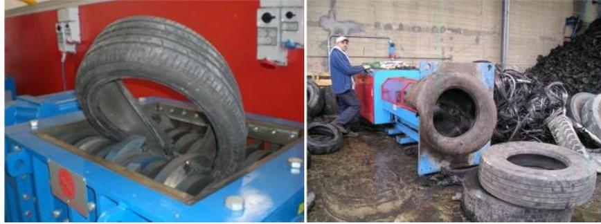
**Fig. 2.10 y 2.11 Entrada y troceado de llanta.**
