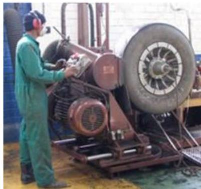
**Fig. 2.5 Preparación de carcasa Reencauchado**
