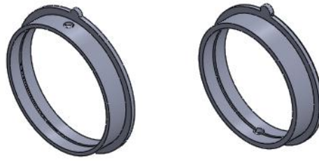
Figura 5.2 Cojinete delantero / Cojinete posterior
