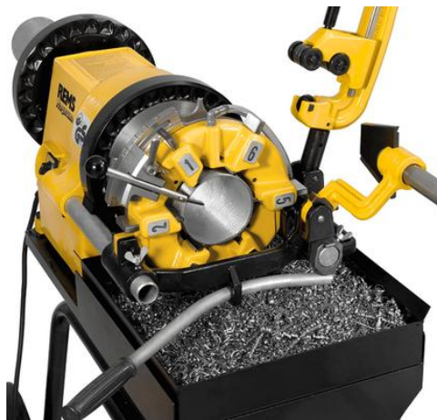
Figura 2.10 Fabricación de roscas en una roscadora
