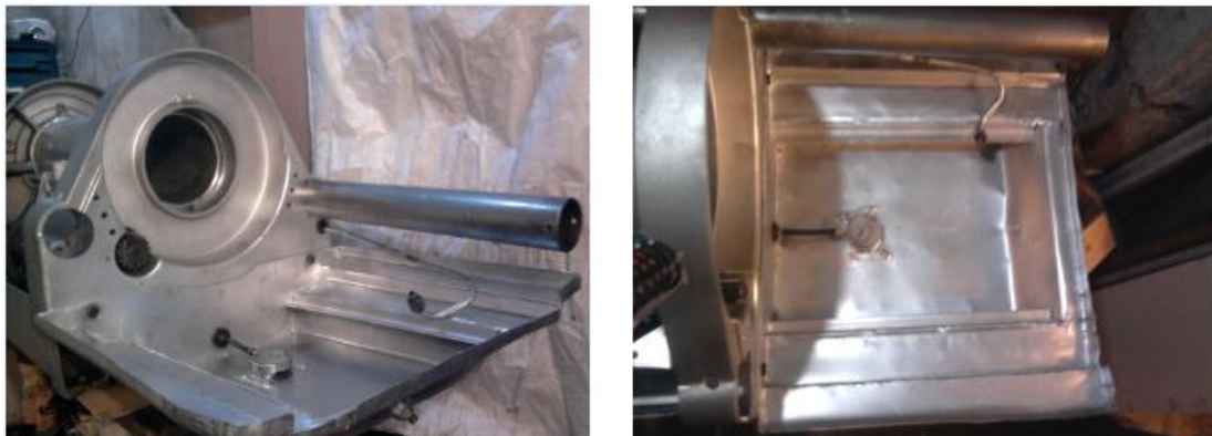
Figura 5.24 Instalación de la bandeja de residuos
