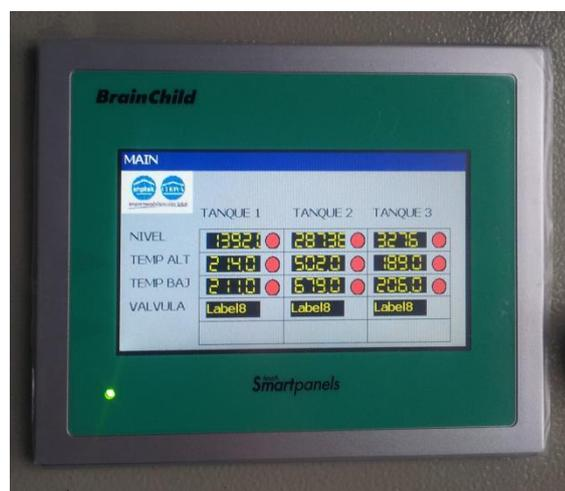
La pantalla recibe alimentación de la fuente de 24VDC y su comunicación con la red de datos, se hace mediante cable Ethernet, debido a que ésta y las tarjetas de adquisición de datos son de la misma marca, y el convertidor de señales tiene facilidad para funcionar de manera adecuada con estos equipos, mientras que con el PLC funciona bien en la lectura de datos.
