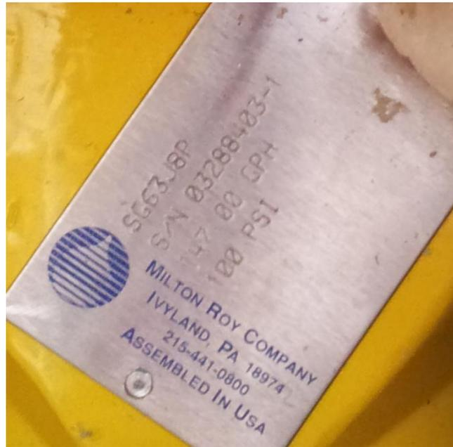
La precisión en el caudal, indicado en el manual de la bomba, es del 2% del 100% de caudal enviado, entre el 10% y 100% del juste del flujo.
