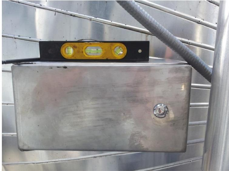
Para la caja se utilizó acero inoxidable (AISI-316), para de esta manera, evitar su oxidación y deterioro debido a los elementos. Sobre la caja están montados los elementos de sujeción de los sensores y hay espacio suficiente para la manipulación de los componentes.
