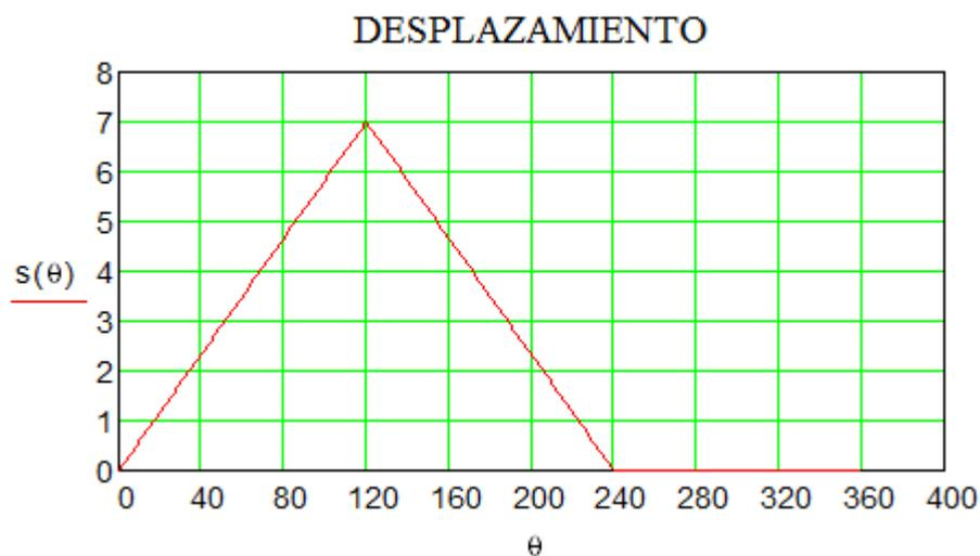
**Figura 3.9. Desplazamiento para la leva de movimiento uniforme**
