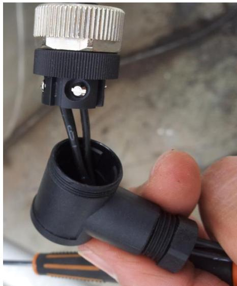
Por otra parte, los accesorios que conectan a los cables de conexión con los sensores, se llaman conectores angulares y lo que hacen es permitir que a través de pernos, los cables se entorchen y conecten en el orden que se
